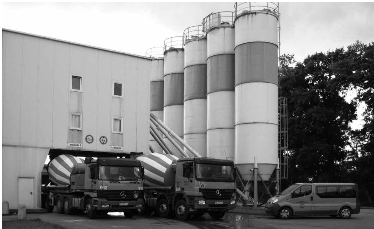
Bild 1: Lieferung von Transportbeton mit dem Fahrmischer
