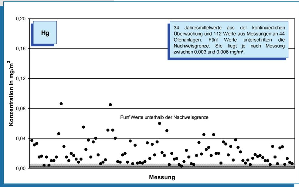
Bild 5-29: Messwerte (Jahr 2007) der Quecksilber-Konzentration im Reingas von 44 Drehofenanlagen.
