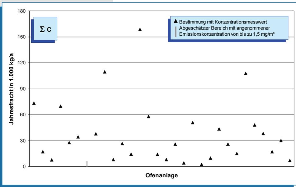
Bild 5-10: Emissionen von organischem Gesamtkohlenstoff (Jahresfracht 2007) von 30 Drehofenanlagen.
