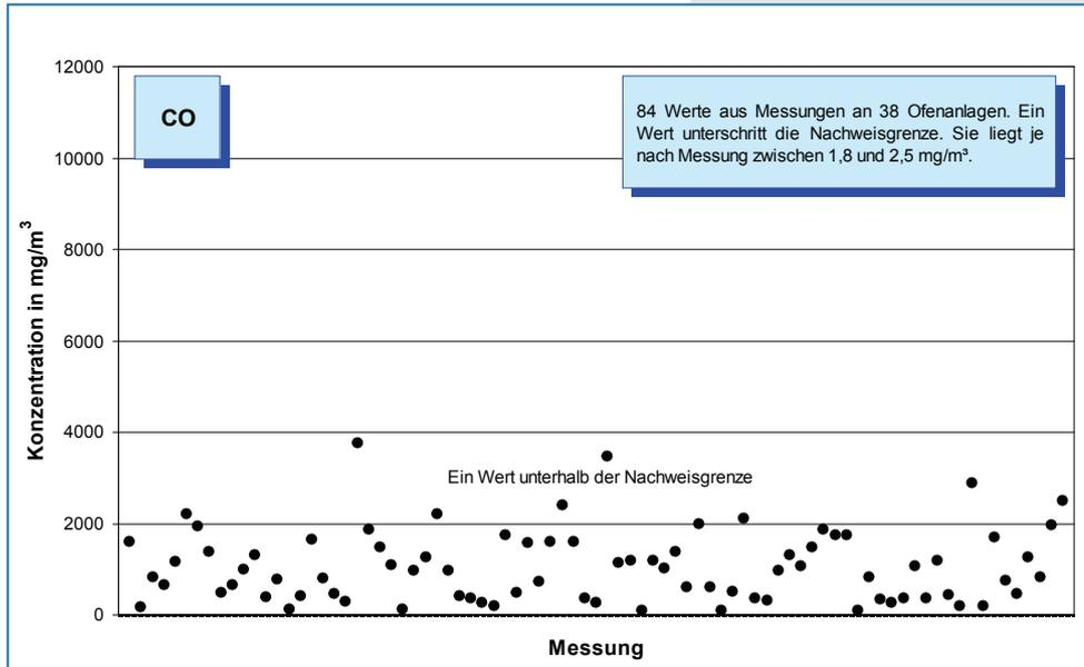
Bild 5-7: Messwerte (Jahr 2007) der CO-Konzentration im Reingas von 38 Drehofenanlagen. In einem Fall konnte kein CO nachgewiesen werden.
