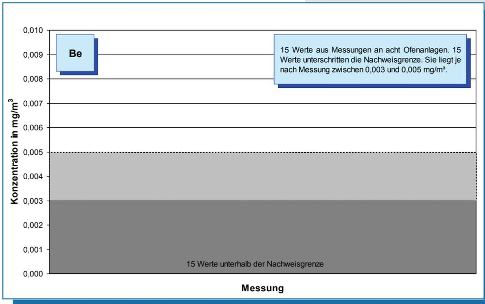
**Bild 5-51: Messwerte (Jahr 2007) der Beryllium-Konzentration im Reingas von acht Drehofenanlagen.**
