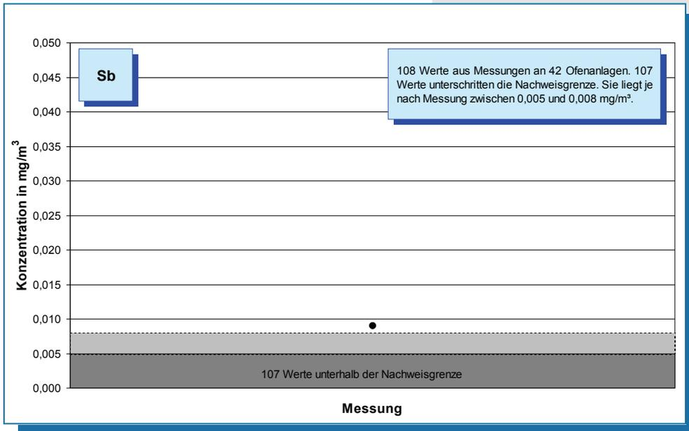
**Bild 5-31: Messwerte (Jahr 2007) der Antimon-Konzentration im Reingas von 42 Drehofenanlagen.**
