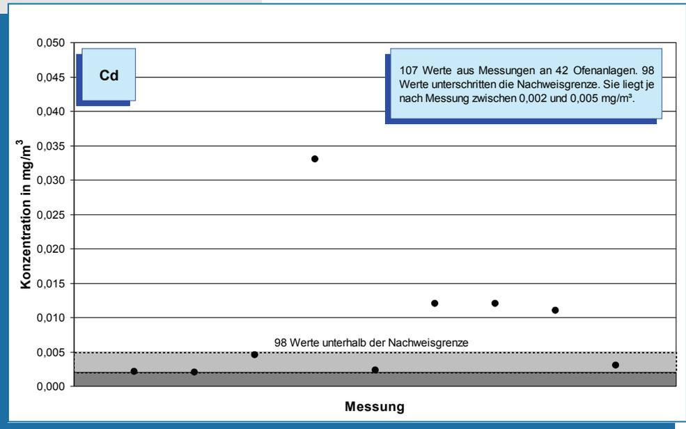
**Bild 5-25: Messwerte (Jahr 2007) der Cadmium-Konzentration im Reingas von 42 Drehofenanlagen.**
