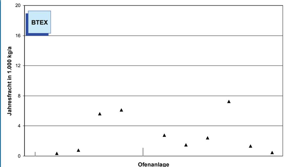
**Bild 5-18:** BTEX-Emissionen (Jahresfracht 2007) von 12 Drehofenanlagen.
