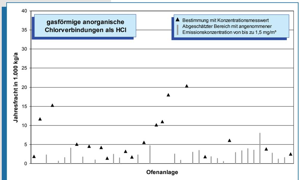
Bild 5-22: HCl-Emissionen (Jahresfracht 2007) von 43 Drehofenanlagen. Bei Messungen unterhalb der Nachweisgrenze kann die Fracht nur abgeschätzt werden. Der Bereich möglicher Emissionen ist in diesen Fällen als Linie dargestellt, deren Obergrenze mit einer Konzentration von 1,5 mg/m<sup>3</sup> berechnet wurde.
