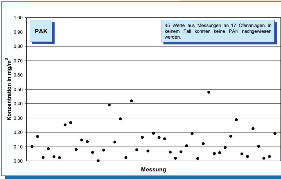
Im Abgas von Drehofenanlagen der Zementindustrie liegt i. Allg. eine Verteilung der PAK (nach EPA 610) vor, in der Naphthalin mit einem Massenanteil von über 90 % dominiert. In Drehofenanlagen der Zementindustrie ist eine praktisch vollständige Zerstörung der aus den Brennstoffen stammenden PAK ge-
