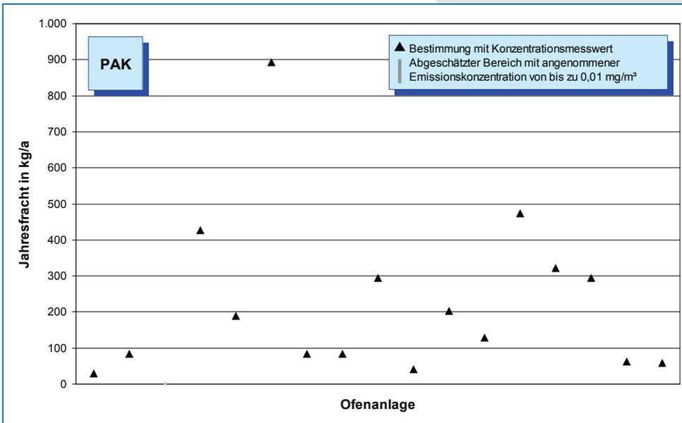
**Bild 5-16:** PAK-Emissionen (Jahresfracht 2007) von 17 Drehofenanlagen.
