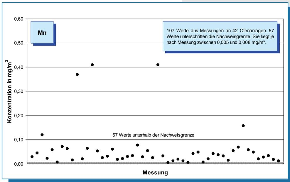
**Bild 5-43: Messwerte (Jahr 2007) der Mangan-Konzentration im Reingas von 42 Drehofenanlagen.**
