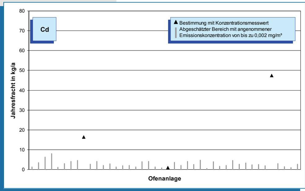
**Bild 5-26: Cadmium-Emissionen (Jahresfracht 2007) von 42 Drehofenanlagen.**
