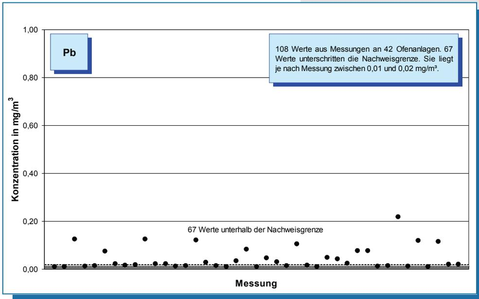
**Bild 5-35: Messwerte (Jahr 2007) der Blei-Konzentration im Reingas von 42 Drehofenanlagen.**
