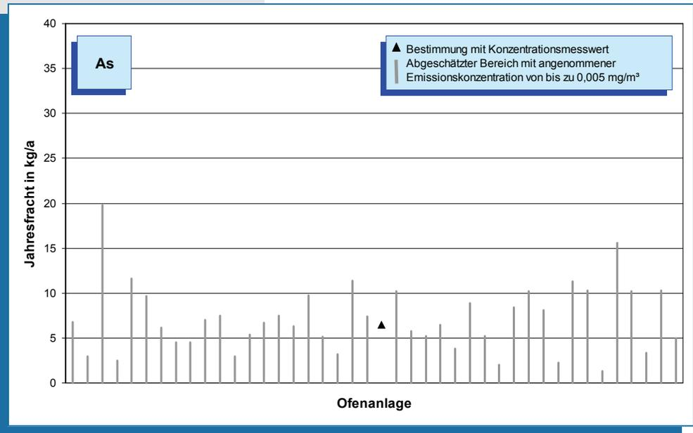
**Bild 5-34: Arsen-Emissionen (Jahresfracht 2007) von 42 Drehofenanlagen.**
