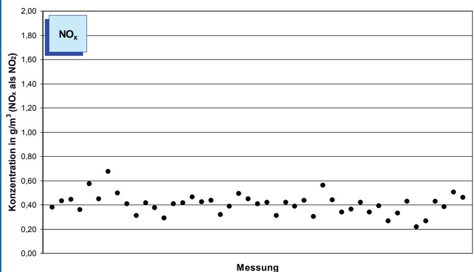
**Bild 5-3: Mittelwerte (Jahr 2007) der NO<sub>x</sub>-Konzentration im Reingas von 45 Drehofenanlagen. Anmerkung: im Jahr 2007 überstiegen die Emissionen mehrerer Anlagen die heute in der TA Luft für Zementwerke vorgesehenen Emissionswerte. Die Betriebsgenehmigungen für diese Werke beruhen noch auf höheren NO<sub>x</sub>-Grenzwerten. Einige dieser Anlagen wurden inzwischen bzw. werden derzeit mit einer Anlage zur NO<sub>x</sub>-Minderung nachgerüstet.**
