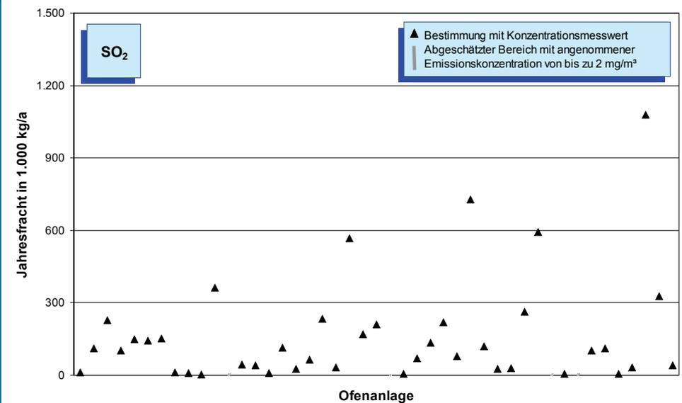
Bild 5-6: SO<sub>2</sub>-Emissionen (Jahresfracht 2007) von 45 Drehofenanlagen.
