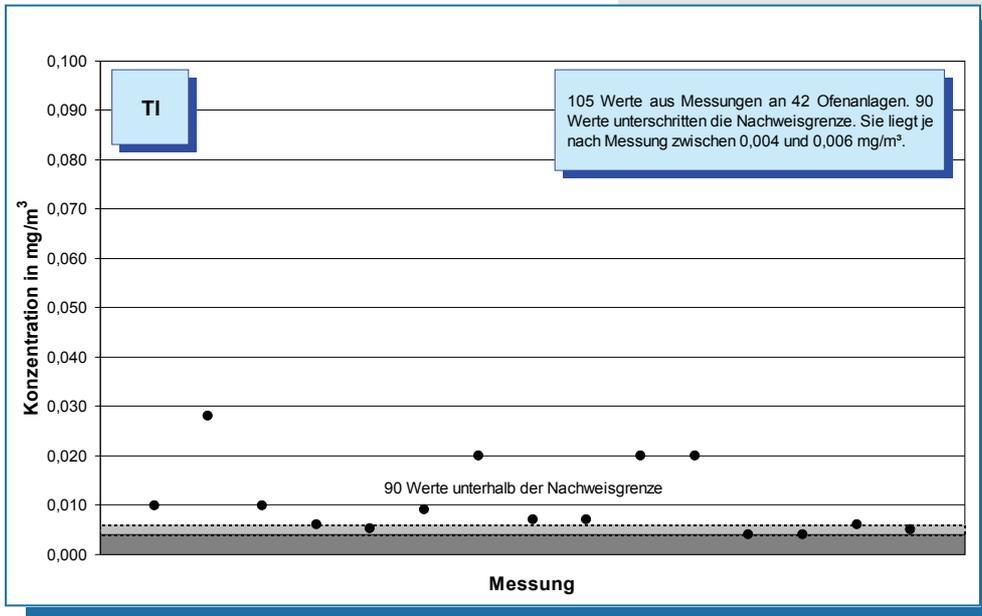
**Bild 5-27: Messwerte (Jahr 2007) der Thallium-Konzentration im Reingas von 42 Drehofenanlagen.**
