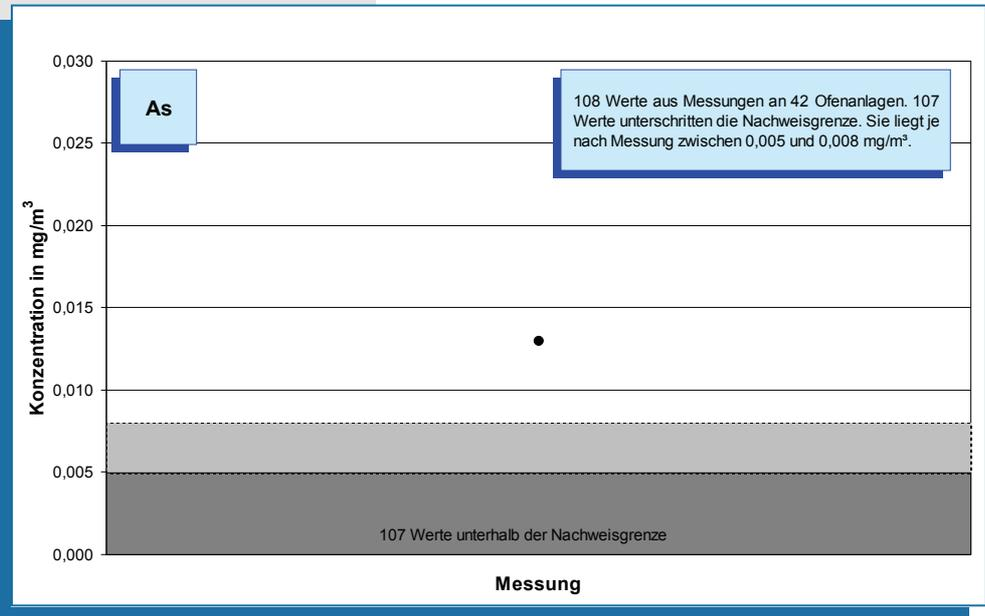
**Bild 5-33: Messwerte (Jahr 2007) der Arsen-Konzentration im Reingas von 42 Drehofenanlagen.**
