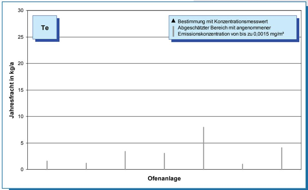
**Bild 5-56: Tellur-Emissionen (Jahresfracht 2007) von sieben Drehofenanlagen.**
