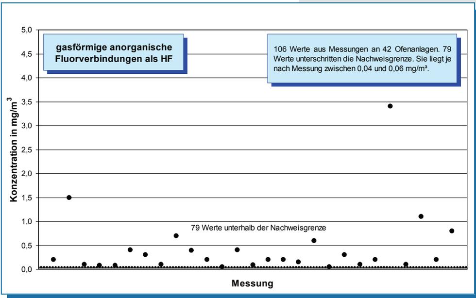
Bild 5-23: Messwerte (Jahr 2007) der Konzentration gasförmiger anorganischer Fluorverbindungen, berechnet als HF, im Reingas von 42 Drehhofenanlagen.
