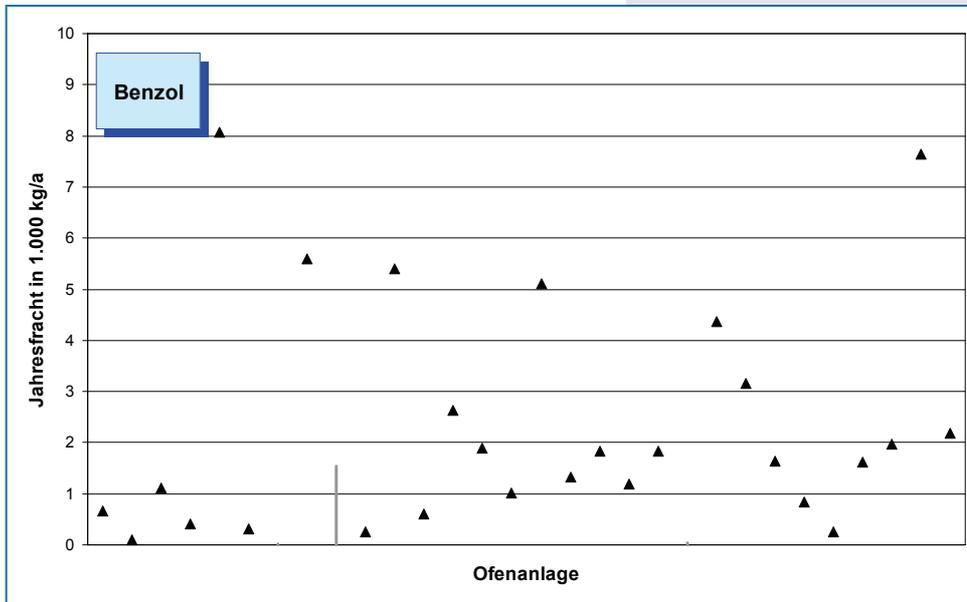
**Bild 5-20:** Benzol-Emissionen (Jahresfracht 2007) von 29 Drehofenanlagen.
