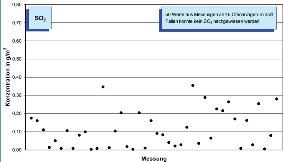
Bild 5-5: Mittelwerte (Jahr 2007) der SO<sub>2</sub>-Konzentration im Reingas von 45 Drehofenanlagen. In acht Fällen konnte kein SO<sub>2</sub> nachgewiesen werden.
