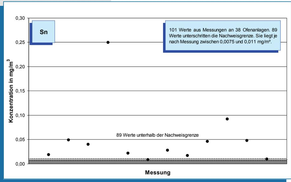
Bild 5-49: Messwerte (Jahr 2007) der Zinn-Konzentration im Reingas von 38 Drehofenanlagen.
