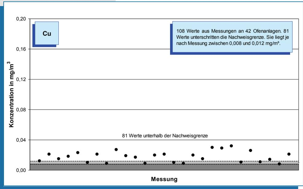
**Bild 5-41: Messwerte (Jahr 2007) der Kupfer-Konzentration im Reingas von 42 Drehofenanlagen.**
