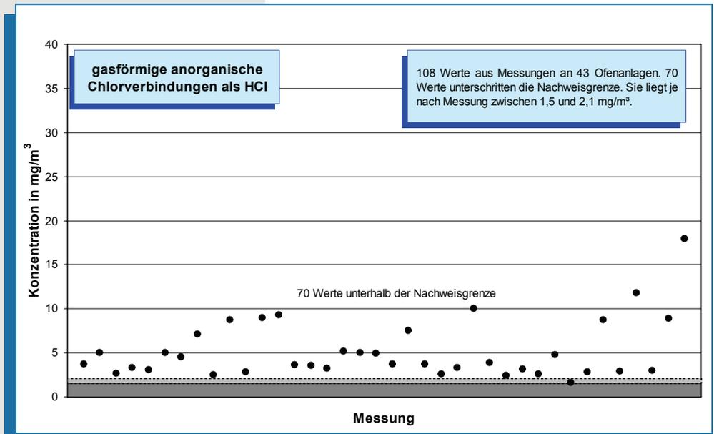
Bild 5-21: Messwerte (Jahr 2007) der Konzentrationen gasförmiger anorganischer Chlorverbindungen, berechnet als HCl, im Reingas von 43 Drehofenanlagen.
