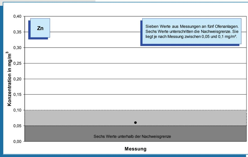
**Bild 5-57: Messwerte (Jahr 2007) der Zink-Konzentration im Reingas von fünf Drehofenanlagen.**
