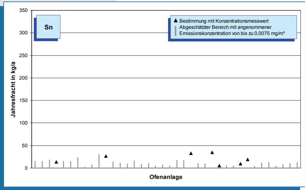
Bild 5-50: Zinn-Emissionen (Jahresfracht 2007) von 38 Drehofenanlagen. Bei Messungen unterhalb der Nachweisgrenze kann die Fracht nur abgeschätzt werden. Der Bereich möglicher Emissionen ist in diesen Fällen als Linie dargestellt, deren Obergrenze mit einer Konzentration von 0,0075 mg/m<sup>3</sup> berechnet wurde.
