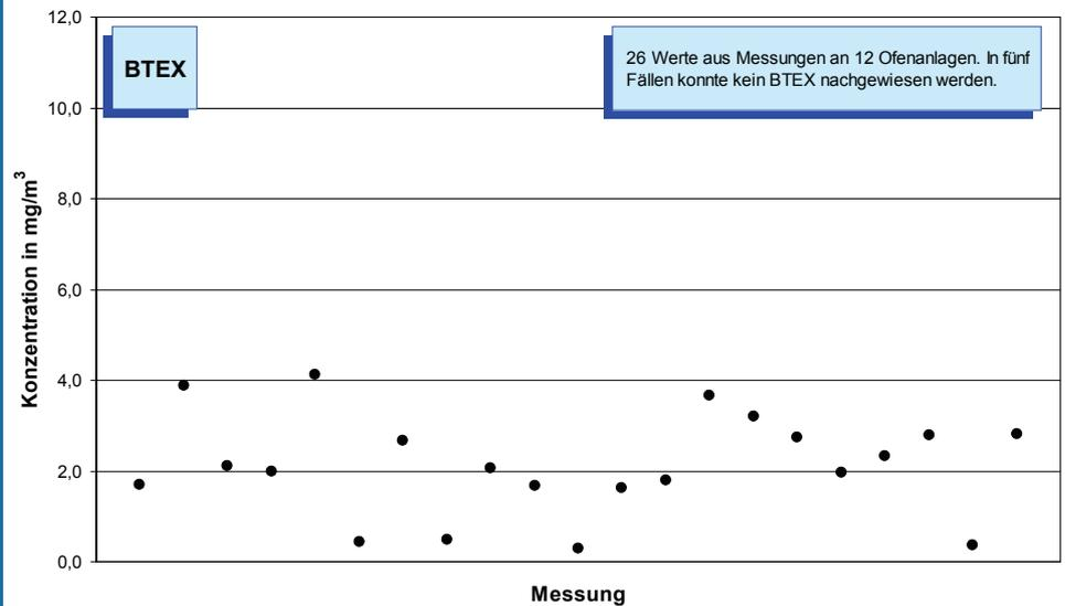
**Bild 5-17:** Messwerte (Jahr 2007) der Konzentration von BTEX im Reingas von 12 Drehofenanlagen. In fünf Fällen konnte kein BTEX nachgewiesen werden. Eine Nachweisgrenze lässt sich aus der Norm nicht ableiten. Bei den eingesetzten Messverfahren sind gemessene Emissionskonzentrationen unterhalb von 0,013 mg/m<sup>3</sup> nicht abgesichert.
