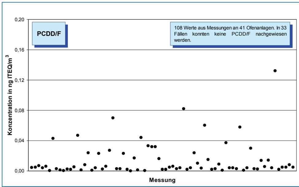
**Bild 5-11: Messwerte (Jahr 2007) der Konzentration von Dioxinen und Furanen (PCDD/F) im Reingas von 41 Drehofenanlagen. In 33 Fällen konnten keine PCDD/F nachgewiesen werden <sup>1)</sup>.**
