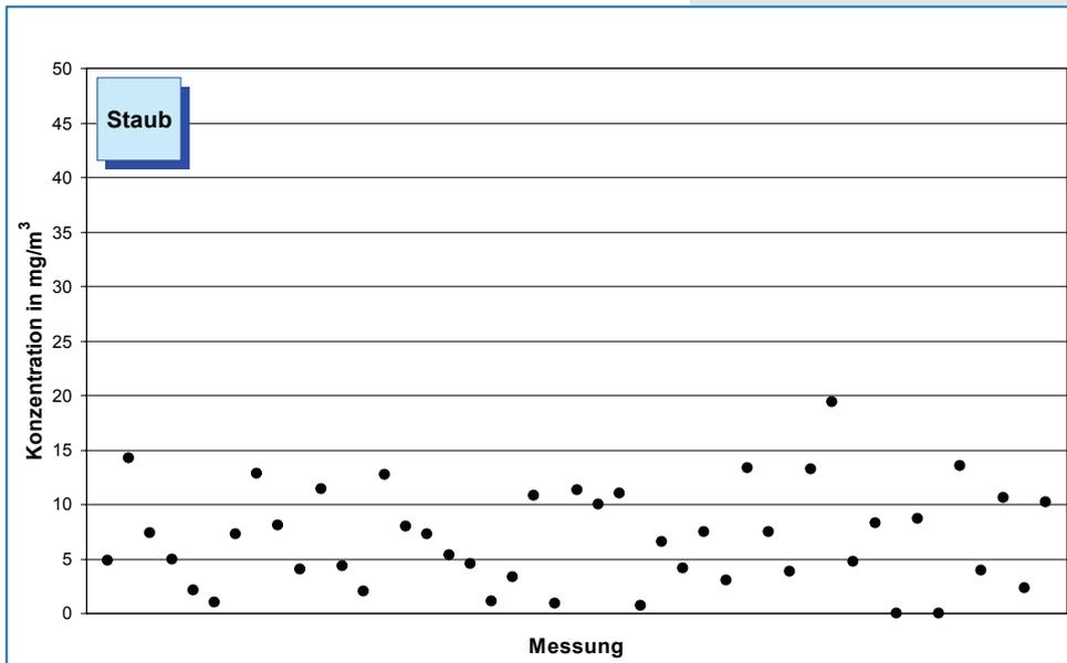
Bild 5-1: Mittelwerte (Jahr 2007) der Staubkonzentration im Reingas von 45 Drehofenanlagen.
