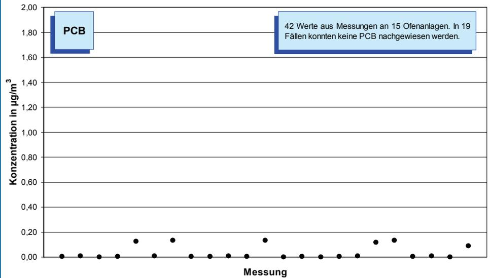
**Bild 5-13:** Messwerte (Jahr 2007) der Konzentration von polychlorierten Biphenylen (PCB nach DIN 51527) im Reingas von 15 Drehofenanlagen. In 19 Fällen konnten keine PCB nachgewiesen werden.
