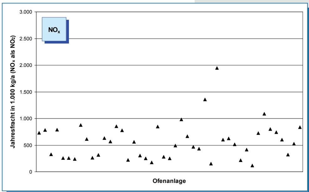
Bild 5-4: NO<sub>x</sub>-Emissionen (Jahresfracht 2007) von 45 Drehofenanlagen.
