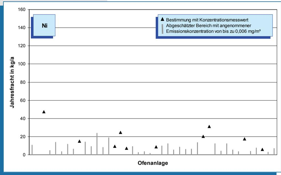
**Bild 5-46: Nickel-Emissionen (Jahresfracht 2007) von 42 Drehofenanlagen.**
