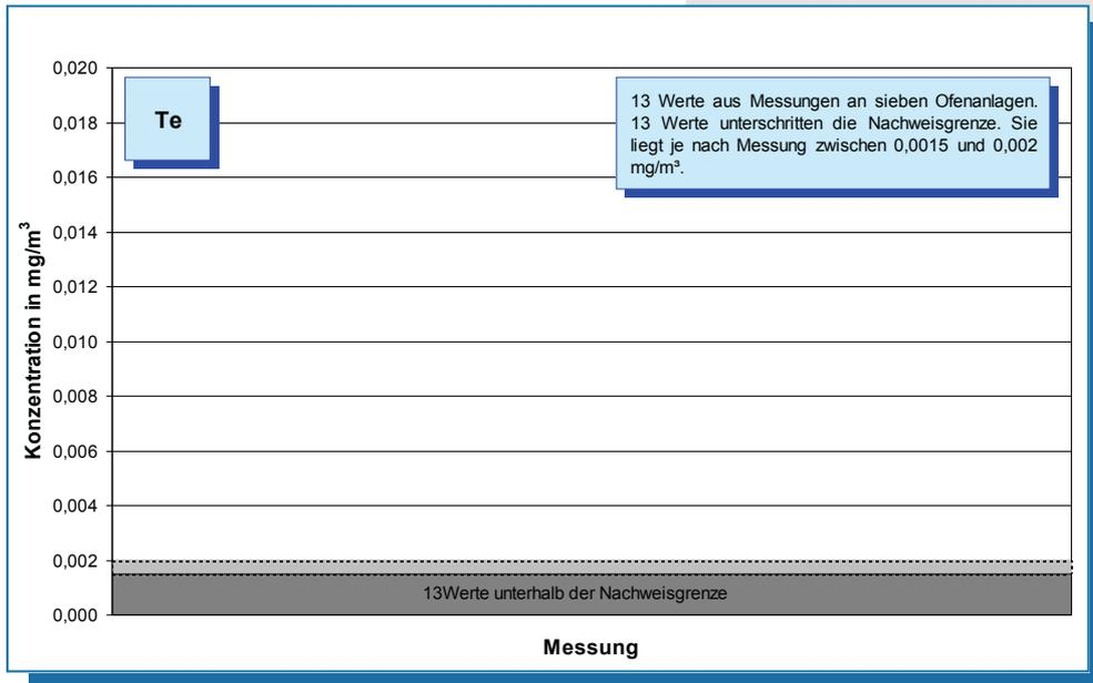
**Bild 5-55: Messwerte (Jahr 2007) der Tellur-Konzentration im Reingas von sieben Drehofenanlagen.**
