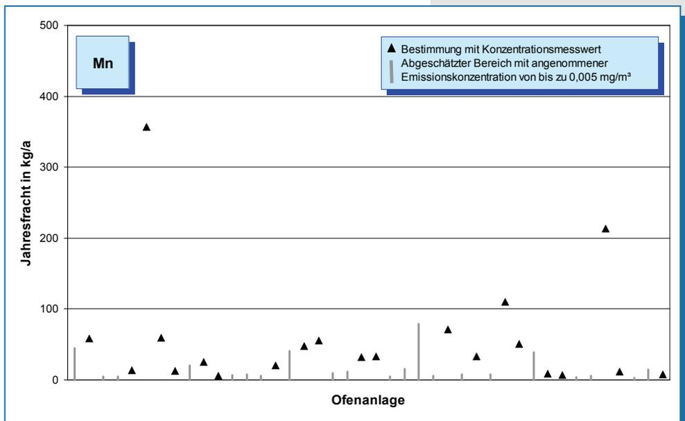
**Bild 5-44: Mangan-Emissionen (Jahresfracht 2007) von 42 Drehofenanlagen.**
