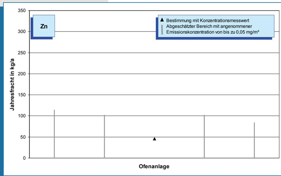
**Bild 5-58: Zink-Emissionen (Jahresfracht 2007) von fünf Drehofenanlagen.**
