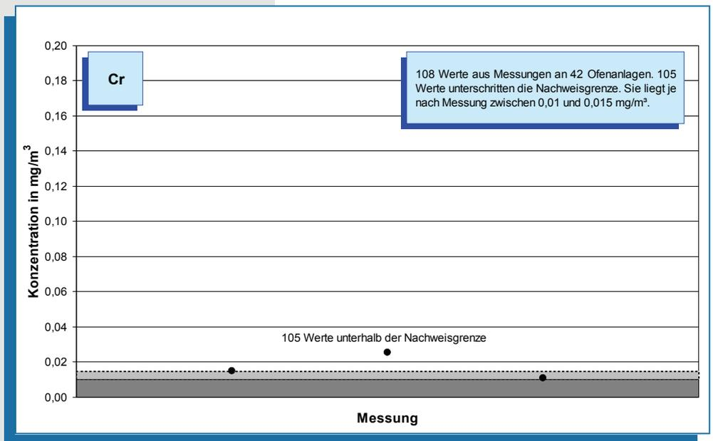
**Bild 5-37: Messwerte (Jahr 2007) der Chrom-Konzentration im Reingas von 42 Drehofenanlagen.**
