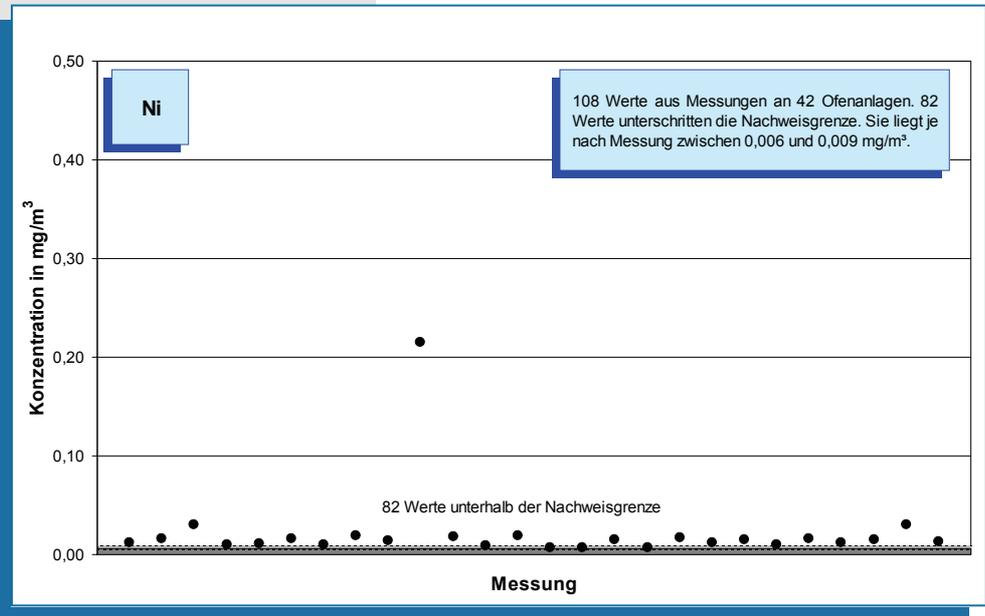
**Bild 5-45: Messwerte (Jahr 2007) der Nickel-Konzentration im Reingas von 42 Drehofenanlagen.**
