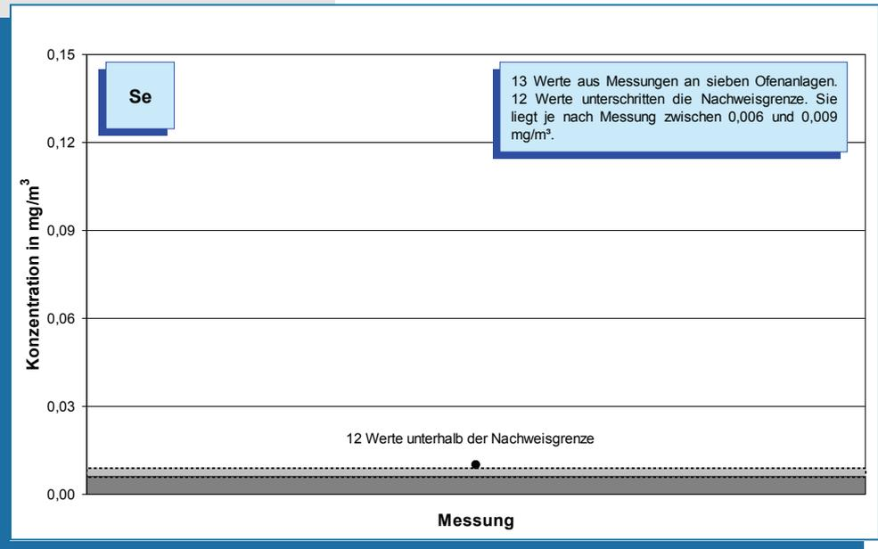
**Bild 5-53: Messwerte (Jahr 2007) der Selen-Konzentration im Reingas von sieben Drehofenanlagen.**
