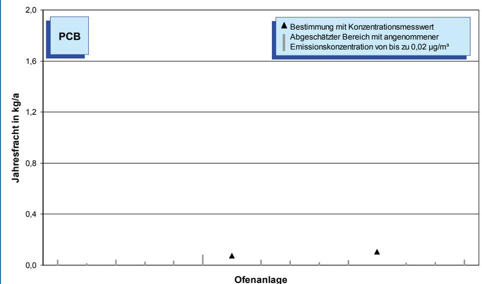
**Bild 5-14:** PCB-Emissionen (Jahresfracht 2007) von 15 Drehofenanlagen.
