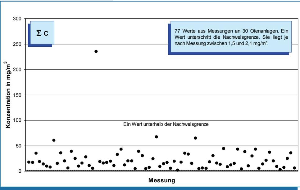
Bild 5-9: Messwerte (Jahr 2007) der Konzentration von organischem Gesamtkohlenstoff im Reingas von 30 Drehofenanlagen.
