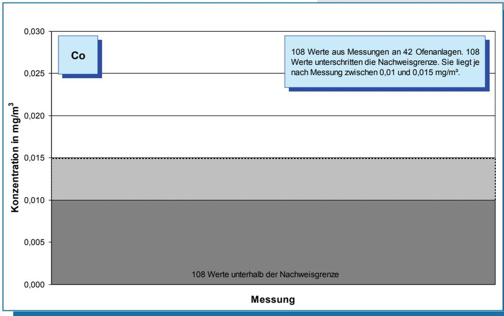
**Bild 5-39: Messwerte (Jahr 2007) der Cobalt-Konzentration im Reingas von 42 Drehofenanlagen.**
