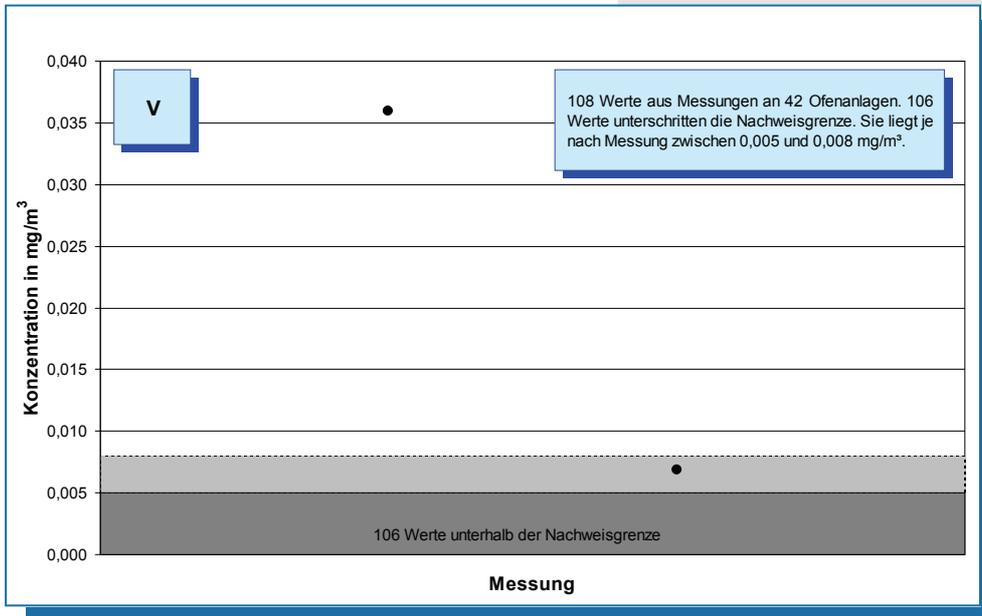
**Bild 5-47: Messwerte (Jahr 2007) der Vanadium-Konzentration im Reingas von 42 Drehofenanlagen.**
