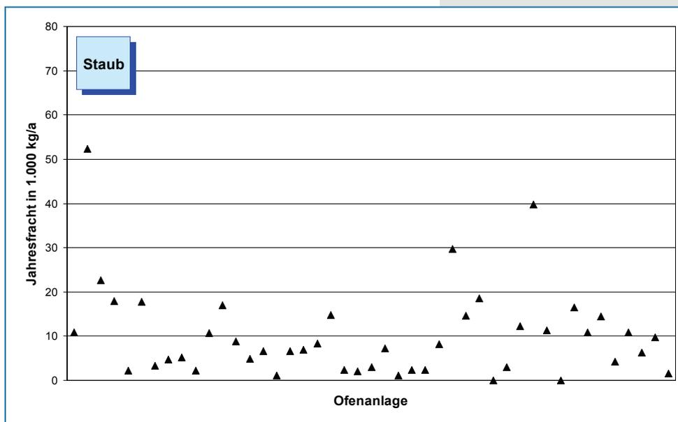
Bild 5-2: Staub-Emissionen (Jahresfracht 2007) von 45 Drehofenanlagen.
