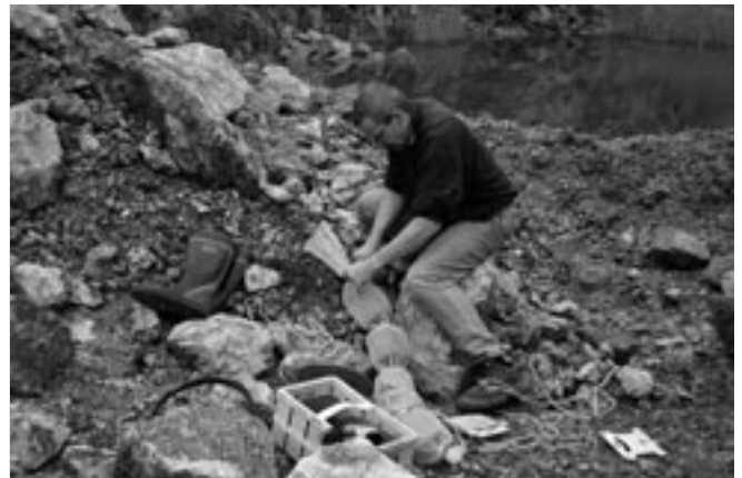
Bild V-38: In grobmaschiger Kunststoffgaze eingepackte Betonwürfel vor der Auslagerung im dahinter zu sehenden gipswassergesättigten See.
