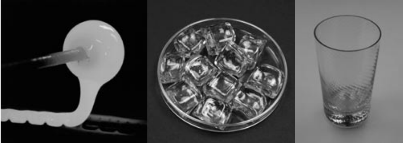
Bild III-12: Herstellung und Verarbeitung von bypassstaubhaltigen Versuchs-Pellets
