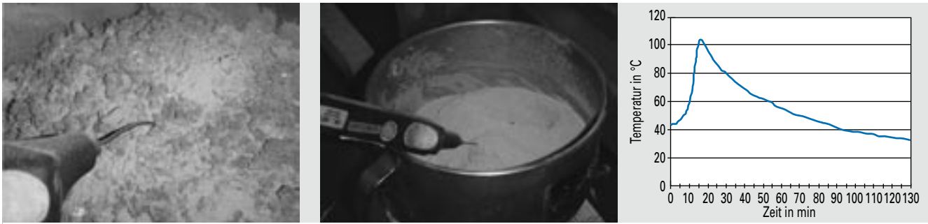
Bild IV-9: Versuche zum Vorlöschen von kalkhaltigem Tragschichtbinder: Aussehen des Tragschichtbinders direkt nach dem Mischen (links), nach Ende des Ablöschvorgangs (Mitte) sowie Temperaturentwicklung beim Ablöschen (rechts)
