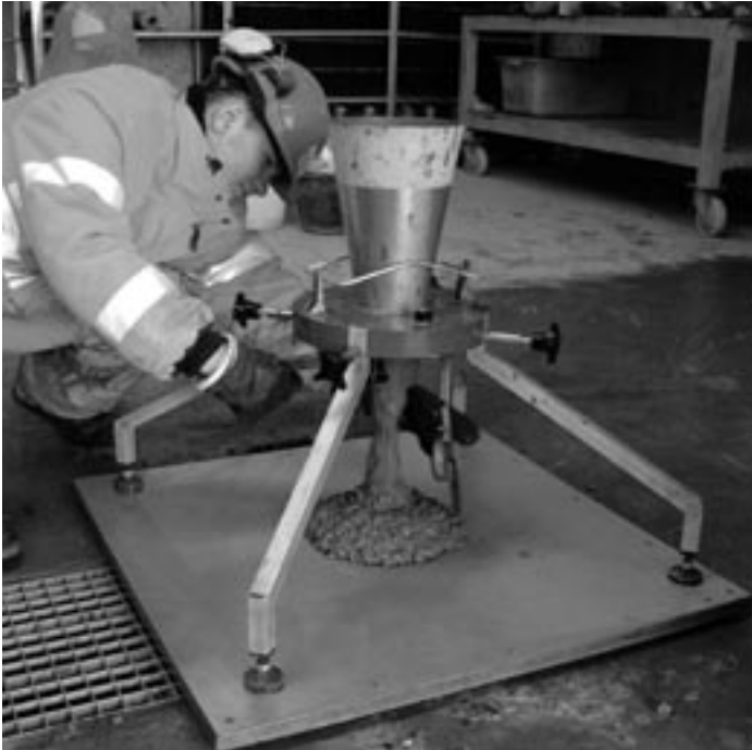
Bild V-44: VDZ-Auslauf- kegel zur Be- stimmung der Frischbeton- eigenschaften von SVB im Baustellenein- satz
