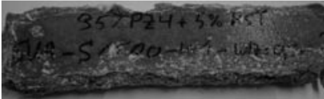
Bild III-29: Mörtelflachprisma aus Portlandzement (CEM I 32,5 R) mit 5 M.-% Kalksteinmehl als Nebenbestandteil nach 24 Monaten Lagerung in Natriumsulfatlösung (1500 mg SO 4 /l) bei 8 °C
