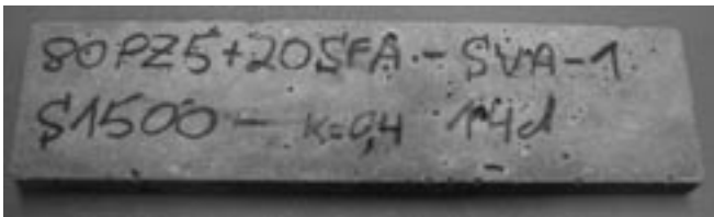
Bild III-31: Mörtelflachprisma aus einem Gemisch mit 80 M.-% CEM II/A-LL 32,5 R und 20 M.-% SFA (k = 0,4) nach 24 Monaten Lagerung in Natriumsulfatlösung (1500 mg SO 4 /l) bei 8 °C
