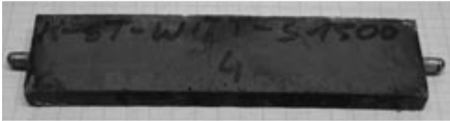
Bild III-27: Mörtelflachprisma aus HS-Portlandzement (CEM I 32,5 R-HS) nach 24 Monaten Lagerung in Natriumsulfatlösung (1500 mg SO 4 /l) bei 8 °C.
