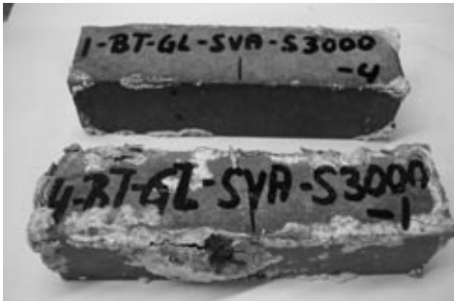
Bild V-37: Betonprüfkörper (w/z = 0,60) auf Basis von Portlandzement (CEM I 32,5 R) und Quarz-Kies- (im Bild oben) bzw. Kalksteinsplitt-Gesteinskörnung (im Bild unten) nach 40 Monaten Lagerung in 0,44%iger Natriumsulfatlösung bei 8 °C.
