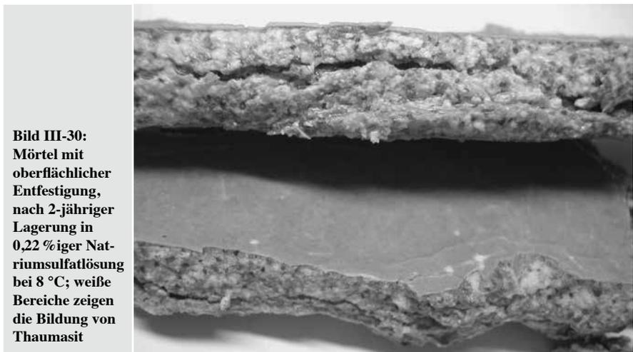
**Bild III-30:** Mörtel mit oberflächlicher Entfestigung, nach 2-jähriger Lagerung in 0,22 %iger Natriumsulfatlösung bei 8 °C; weiße Bereiche zeigen die Bildung von Thaumasit
