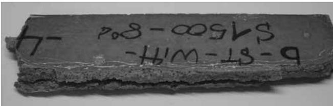
**Bild III-27:** Mörtelfachprisma aus einem Bindemittelgemisch mit 80 M.-% CEM I 32,5 R und 20 M.-% SFA (w/z = 0,60, k = 1) nach 18 Monaten Lagerung in 0,22 % iger Natriumsulfatlösung bei 8 °C
