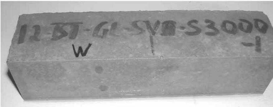
**Bild V-26:** Betonprüfkörper ( $w/z = 0,60$ ) auf Basis von HS-Zement (CEM III/B-HS) und Kalksteinsplitt nach 45 Monaten Lagerung in 0,44 %iger Natriumsulfatlösung bei 8 °C
