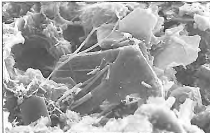
Bild 6 Friedelsches Salz in einer Pore; REM-Aufnahme
