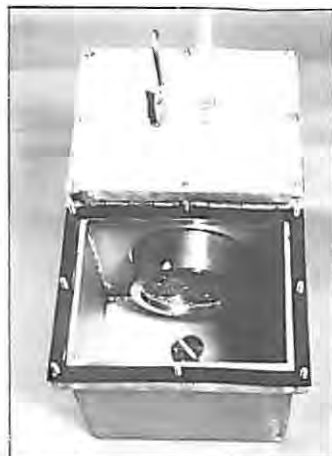
Bild 4 Zwei-Kammer-Versuchseinrichtung mit eingebauter Betonprobe
