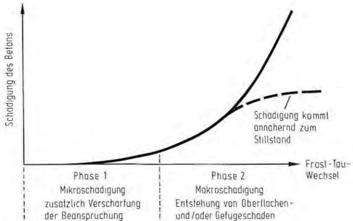
**Bild 2** Schädigungsverlauf bei einem Beton mit nicht ausreichendem Widerstand gegen Frost- bzw. Frost-Tausalz-Widerstand.
