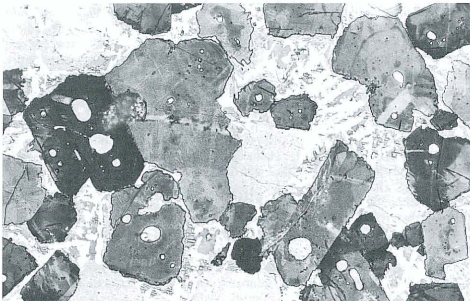
Abb. 2: Mikrogefüge eines Portlandzementklinkers (geätzter Anschliff eines Klinkerkorns im Auflichtmikroskop). Mineralphasen: Alit ( \text{Ca}_3\text{SiO}_5 , dunkelgrau bis schwarz) mit kleinen Einschlüssen von Belit-Kristallen ( \text{Ca}_2\text{SiO}_4 , hellgrau), rundliche Kristalle sekundären Belits, feinkristalline Zwischenmasse mit Aluminat ( \text{Ca}_3\text{Al}_2\text{O}_6 , dunkelgrau) und Ferrit ( \text{Ca}_4\text{Al}_2\text{Fe}_2\text{O}_{10} , hell).
