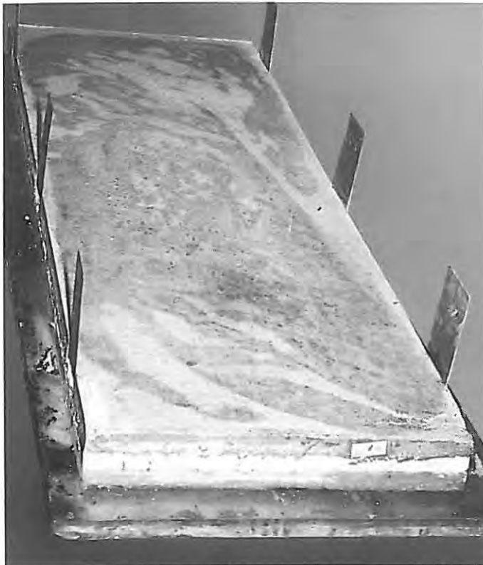
Bild 7 Probeplatte (168 cm x 60 cm) eines Fließestrichs auf Dämmschicht; 40 mm Estrichmörtel auf 85 mm zweilagiger Dämmschicht
