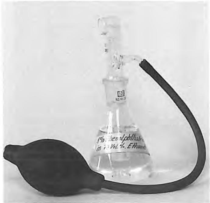
Bild 1 Geeignete Laborsprühflasche
