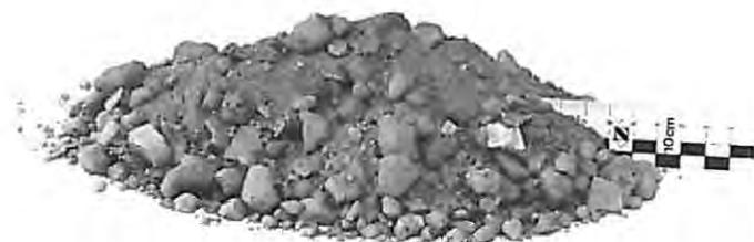
Bild 1 Rostasche aus der Müllverbrennungsanlage Düsseldorf
