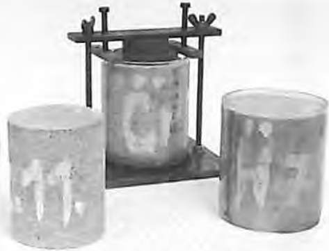
Bild 5 Einsetzen, Zentrieren und Einkleben des Prüfkörpers in einen Acrylglaszylinder
