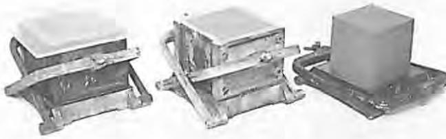
Bild 3 Unterschiedliche Umschließung der Probekörper (Formzustand) während der Wärmebehandlung bei den Laborversuchen
