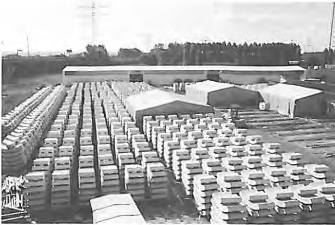
Bild 1 Serienfertigung von Betonfertigteilen in einer Feldfabrik Foto: Cürllis
