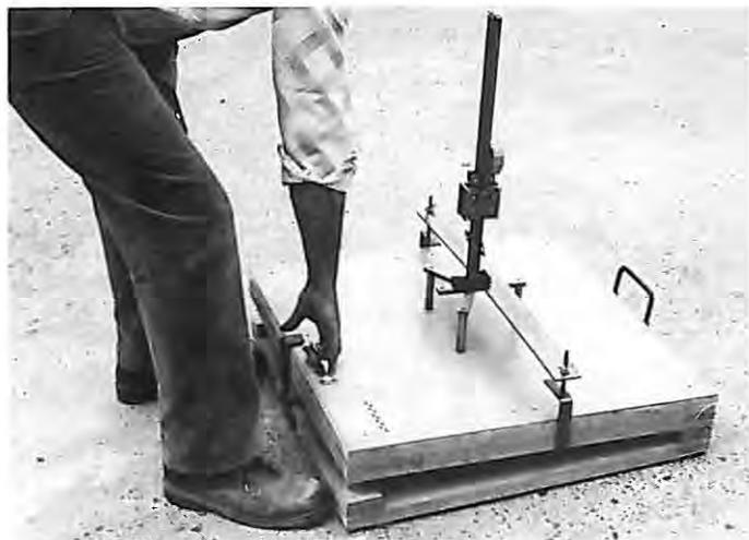
Bild 2 Schlagmeßgerät (Gesamtaufbau)
