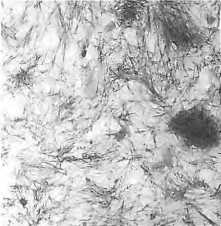
Bild 7 Faserverteilung beim Herstellverfahren 3a nach Tafel 4 (Platte A nach Bild 2 aus Beton 1.4.2)
