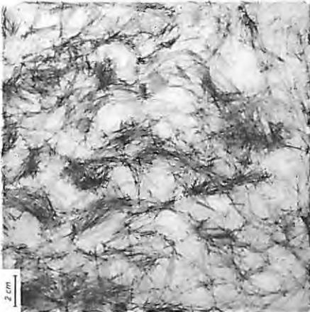
Bild 9 Orientierung der Stahlfasern parallel zur Herstelloberseite (Platte A nach Bild 2 aus Beton 2.16)
