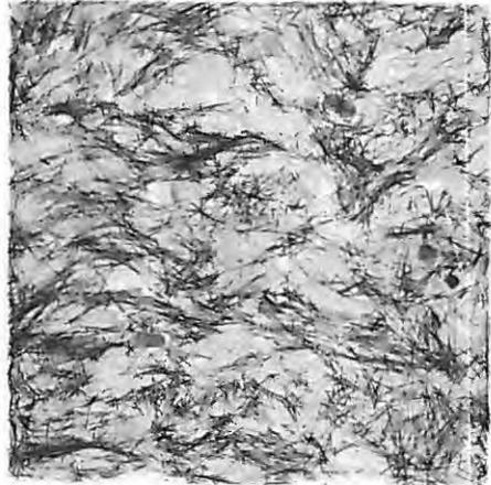
Bild 8 Orientierung der Stahlfasern parallel zur Herstelloberseite (Platte A nach Bild 2 aus Beton 2.8)
