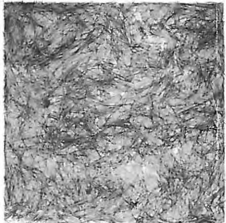
Bild 10 Faserverteilung ohne Orientierung (Platte B nach Bild 2 aus Beton 2.3)
