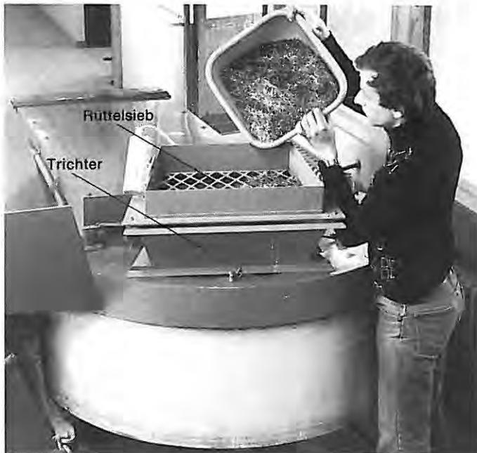
Bild 1 Zugabeeinrichtung für gleichmäßige Verteilung der Stahlfasern, Herstellverfahren 4 nach Tafel 4
