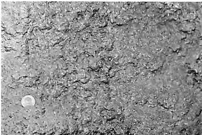
Bild 4 Oberfläche von frisch verarbeitetem Stahlfaserspritzbeton; Lage der Fasern überwiegend senkrecht zur Spritzrichtung
