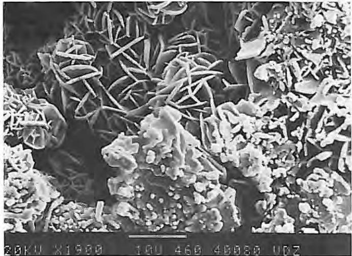
Bild 5 Tafeliges Monosulfat und noppenförmiger Ettringit im Gefüge des Zementsteins nach einer Hydrationsdauer von 45 Minuten; Portlandzement aus Klinker II; Mischungsverhältnis Anhydrit/Halbhydrat = 100/0; w/z = 0,40; REM-Aufnahme
