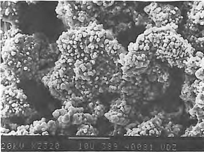
Bild 6 Noppenförmiger Ettringit im Gefüge des Zementsteins nach einer Hydrationsdauer von 45 Minuten; Portlandzement aus Klinker II, Mischungsverhältnis Anhydrit/Halbhydrat = 50/50; w/z = 0,40; REM-Aufnahme
