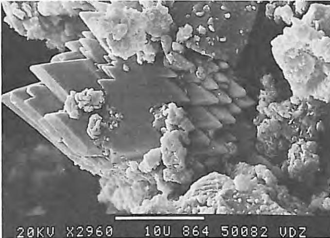
Bild 20 Gefüge des Zementsteins nach einer Hydrationsdauer von 5 Stunden mit Zusatz von 0,2 Gew.-% Zucker; durch die Ausbildung des Sekundärgipses in Form gedrungener Aggregate wird das Erstarren deutlich verzögert; Mischungsverhältnis Anhydrit/Halbhydrat = 0/100; w/z = 0,40; REM-Aufnahme
