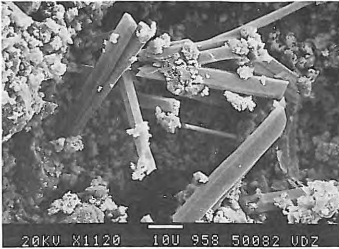
Bild 19 Gefüge des Zementsteins nach einer Hydrationsdauer von 45 Minuten ohne Zusatz; leistenförmige Ausbildung von Sekundärgips führt zu schnellem Erstarren; Mischungsverhältnis Anhydrit/Halbhydrat = 0/100; w/z = 0,40; REM-Aufnahme
