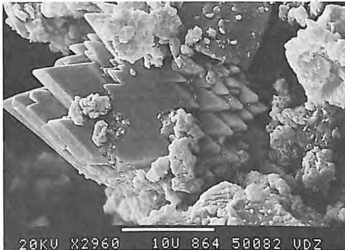
Bild 20 Gefüge des Zementsteins nach einer Hydratationsdauer von 5 Stunden mit Zusatz von 0,2 Gew.-% Zucker; durch die Ausbildung des Sekundärgipses in Form gedrungener Aggregate wird das Erstarren deutlich verzögert; Mischungsverhältnis Anhydrit/Halhydrat = 0/100; w/z = 0,40; REM-Aufnahme
