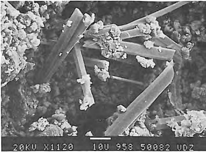
Bild 19 Gefüge des Zementsteins nach einer Hydratationsdauer von 45 Minuten ohne Zusatz; leistenförmige Ausbildung von Sekundärgips führt zu schnellem Erstarren; Mischungsverhältnis Anhydrit/Halhydrat = 0/100; w/z = 0,40; REM-Aufnahme
