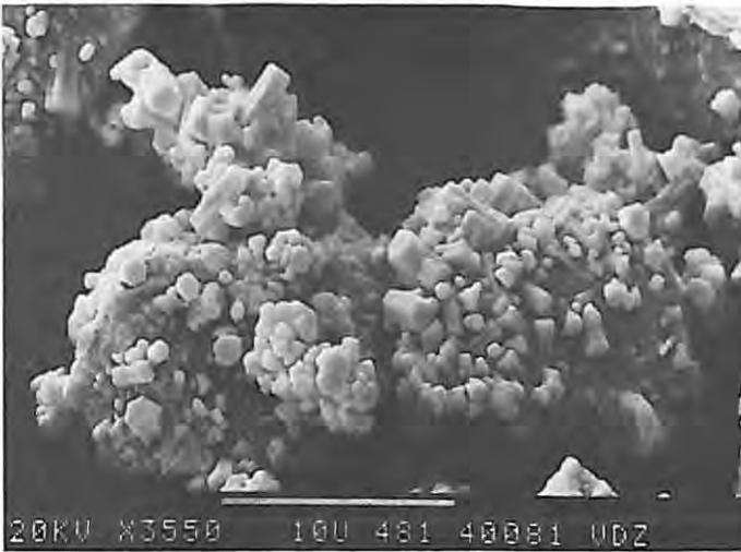
Bild 17 Gefüge des Zementsteins nach einer Hydratationsdauer von 6 Stunden mit Zusatz eines wirksamen Verzögerers; das Längenwachstum des Ettringits wird gehemmt, das Erstarren infolgedessen verzögert; Portlandzement aus Klinker A; Anhydrit/Halbhydrat = 40/60; Zusatz: 0,2 Gew.-% Zitronensäure; w/z = 0,40; REM-Aufnahme
