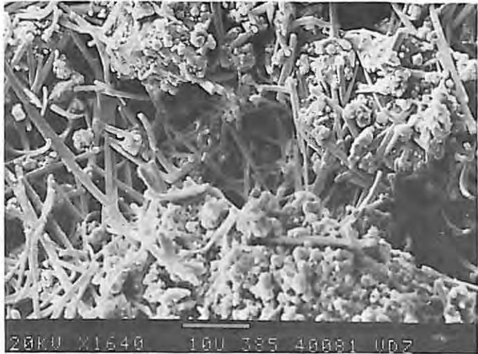
Bild 18 Gefüge des Zementsteins nach einer Hydrationsdauer von 45 Minuten mit einem für die Zusammensetzung des Zements ungeeigneten Zusatz; Ettringit mit ausgeprägtem Längenwachstum nach relativ kurzer Hydratation; Portlandzement aus Klinker A; Anhydrit/Halbhydrat = 90/10; Zusatz: 0,2 Gew.-% Zitronensäure; w/z = 0,40; REM-Aufnahme
