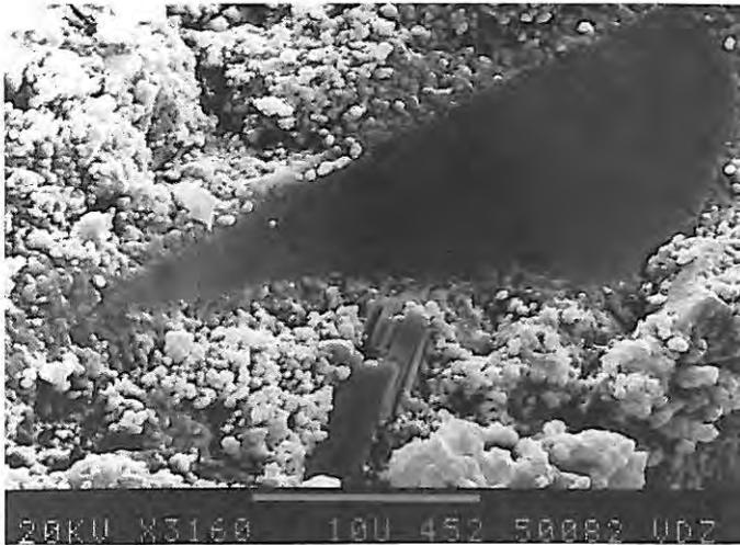
Bild 11 Gespaltenes Hüttensandkorn mit dichtem Reaktionssaum in einem 2 Jahre alten HOZ-Beton, REM-Aufnahme
