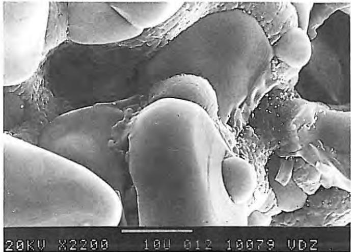
Bild 5 Gefüge eines Portlandzementklinkers, REM-Aufnahme
