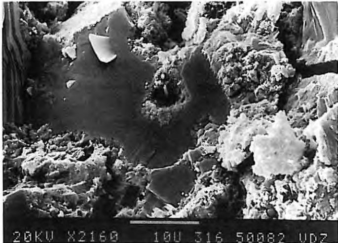
Bild 20 Kalksteinkorn im Zementstein, mit Hydratationsprodukten belegt, Wasser/(Zement + Kalkstein) = 0,30, Hydrationsdauer 28 Tage (Wasserlagerung), REM-Aufnahme
