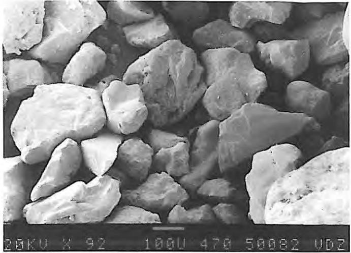
Bild 22 Quarzsand im Anlieferungszustand, REM-Aufnahme
