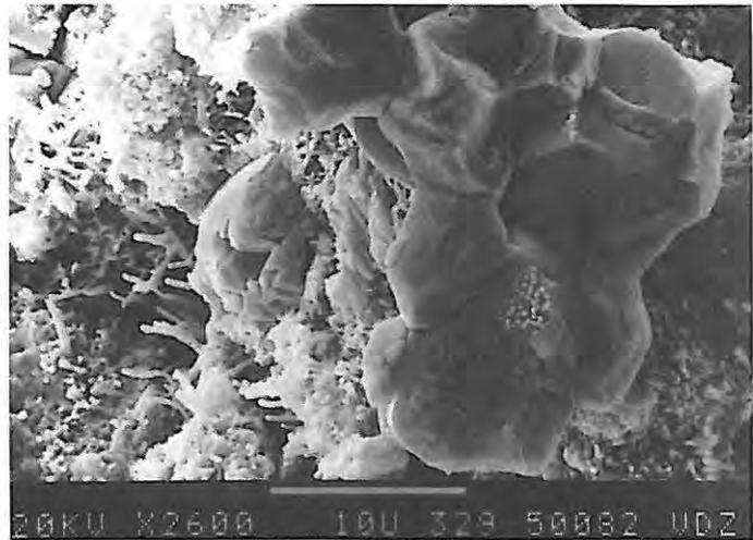
Bild 23 Quarzkorn mit praktisch glatter Oberfläche im Zementstein, Wasser/(Zement + Quarzsand) = 0,30, Hydrationsdauer 28 Tage (Wasserlagerung), REM-Aufnahme
