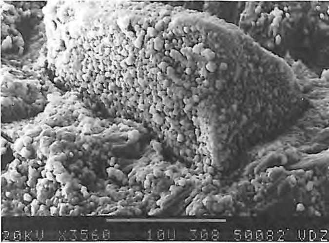
Bild 10 Hüttensandkorn im Zementstein mit dichtem Besatz von Calciumsilicathydraten, Wasser/(Zement + Hüttensand) = 0,30, Hydrationsdauer 28 Tage (Wasserlagerung), REM-Aufnahme
