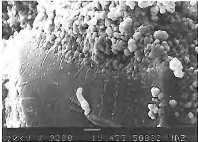
Bild 12 Verbund zwischen Hüttensandkorn und Hydratationsprodukten in einem 7 Jahre alten HOZ-Beton, REM-Aufnahme
