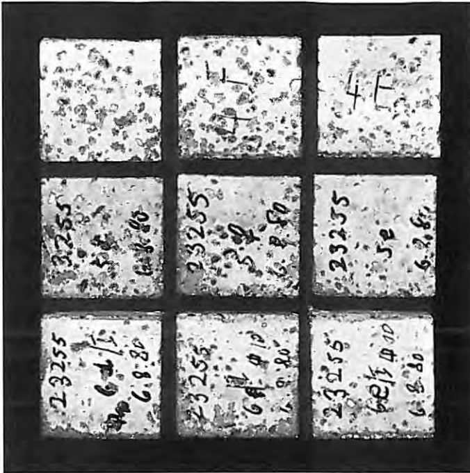
Bild 6 Proben mit unterschiedlichem Mehlkorngelalt nach 50 Frosttauwchseln in 3 %-NaCl-Lösung (oben: 430 kg Mehlkorn/m 3 , Mitte: 500 kg/m 3 , unten: 600 kg/m 3 )
