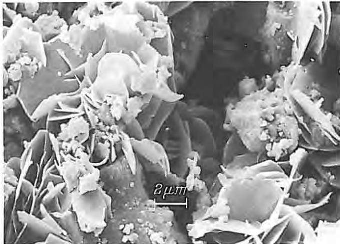
Bild 8 Rasterelektronenmikroskopische Aufnahme eines Zementleims 30 Minuten nach dem Anmachen, bei dem ein zu niedriges Sulfatangebot zur Bildung von Monosulfat und damit schnellem Erstarren geführt hatte
