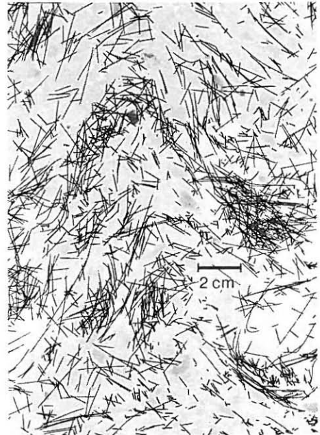
Bild 11 Röntgenaufnahmen von Stahlfaserbetonen mit 32 mm Größtkorn (links) und 16 mm Größtkorn (rechts)
