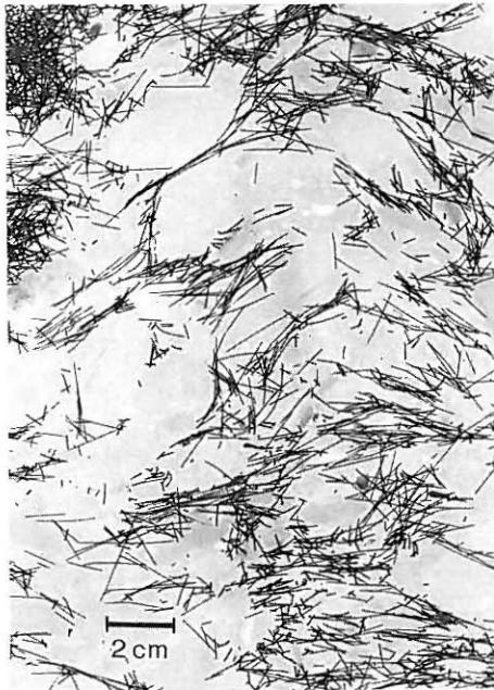
Bild 11 Röntgenaufnahmen von Stahlfaserbetonen mit 32 mm Größtkorn (links) und 16 mm Größtkorn (rechts)
