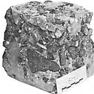
Beton mit Dichtungsmittel DS
