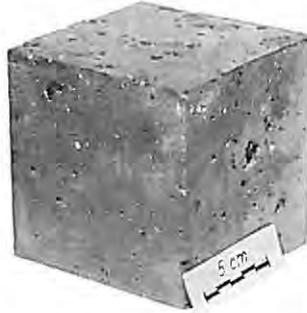
*Fließbeton mit Luftporen*
