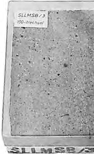
*Fließbeton mit Luftporen*
