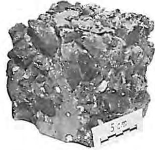
Beton mit Dichtungsmittel DW
