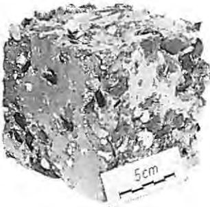
Beton mit Dichtungsmittel DS
