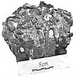
Beton mit Dichtungsmittel DA
