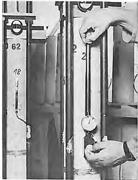
Bild 6 Messen der Kriech- verformungen mit Setzdehnungs- messern (Meßlänge 40 cm) Bauart München
