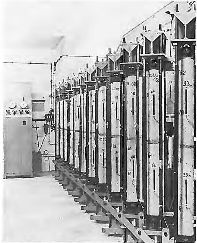
Bild 1 Kriechstände (Bauart MPA München) in einem klimatisierten Raum; die Gesamtverformung der Betonzylinder wird mit Dehnungsmeßstreifen von 15 cm Länge gemessen
