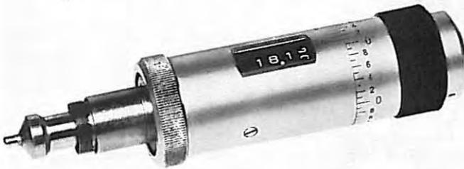
Bild 2 Tiefenmaße zur Ermittlung der Raumänderung bei Einpreßmörtel
