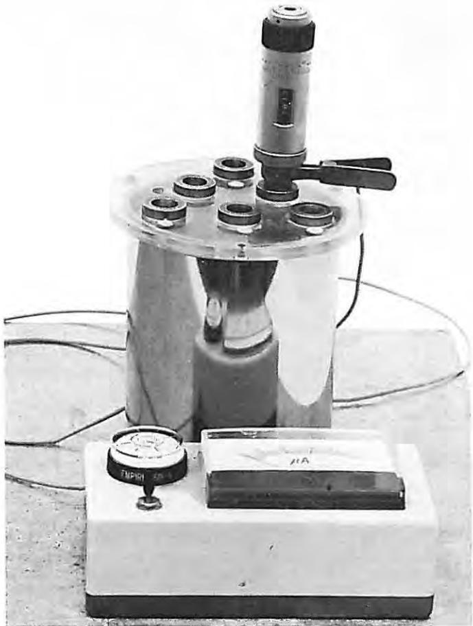
Bild 3 Elektrische Meßvorrichtung zum Bestimmen der Raumänderung bei Einpreßmörtel
