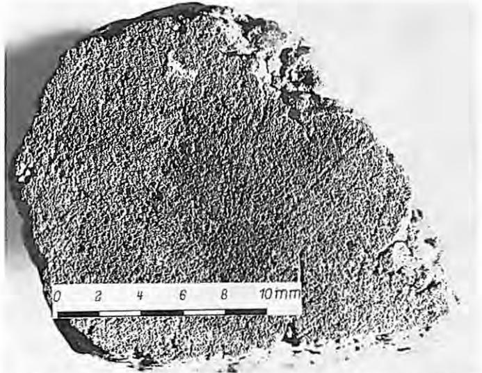
Bild 5 Schnitt durch ein Leichtzuschlagkorn (Blähton) mit gleichmäßig verteilten, feinen Poren
