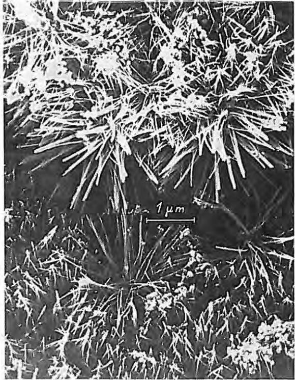
Bild 11 Neubildungen im Anmachwasser (Zementgel) bei der Hydratation der Klinkerkörner (Aufnahme mit dem Raster-Elektronenmikroskop)
