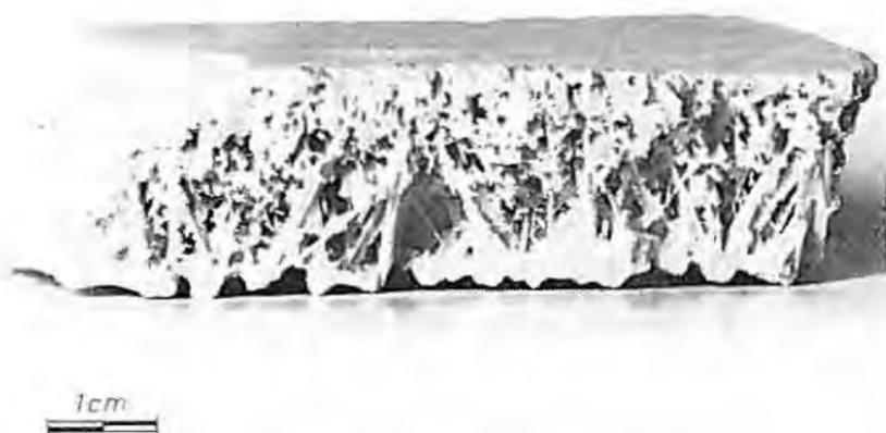
Bild 2 Hohlraumbildung beim Abkühlen dicker Schwefelschichten
