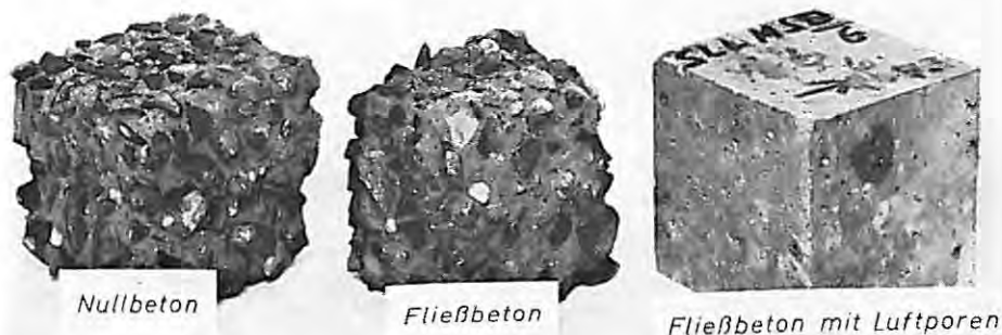
Bild 12 10-cm-Würfel aus Ausgangsbeton (ohne LP-Mittel), aus Fließbeton (ohne LP-Mittel) und aus Fließbeton mit LP-Mittel nach 50 Frost-Tau-Wechseln in 3%iger NaCl-Lösung
