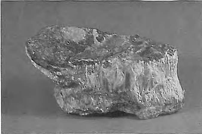
Bild 10 Chrysotilasbest im Muttergestein
