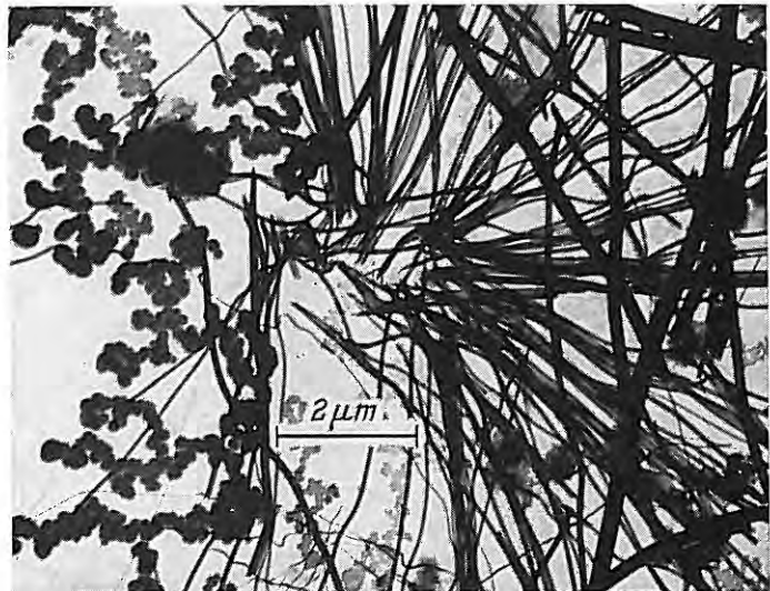
Bild 7 Elektronenmikroskopische Aufnahme von Calciumsilicathydrat-Fasern, die durch längeres Schütteln einer Suspension bei + 5 °C entstanden sind
