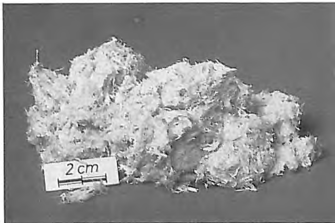
Bild 11 Wolle aus aufbereitetem Chrysotilasbest
