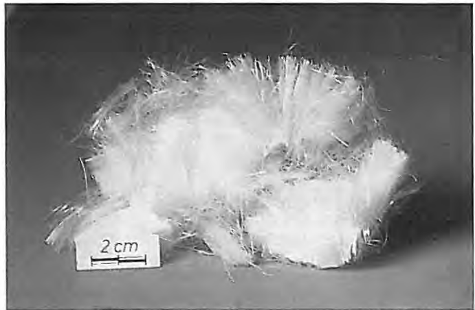
Bild 13 Kunststoff-Fasern aus Polypropylen
