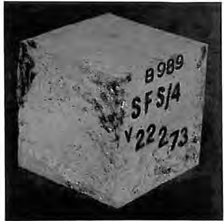
Bild 20 Würfel aus Stahl- faserbeton nach halb- jähriger ungeschütz- ter Lagerung im Freien
