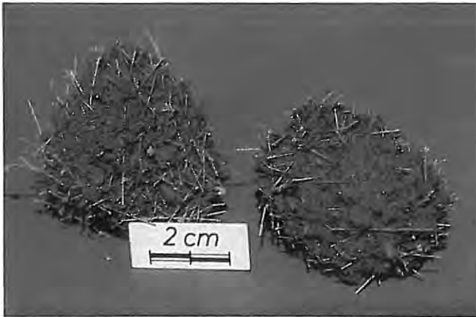
Bild 19 Tennisballgroße „Stahligel“ durch Aufrollen kurzer Stahlfasern in der Mischmaschine
