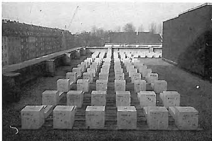
Bild 9 Lagerung auf einem Dach des Instituts (Freiluftlagerung)
