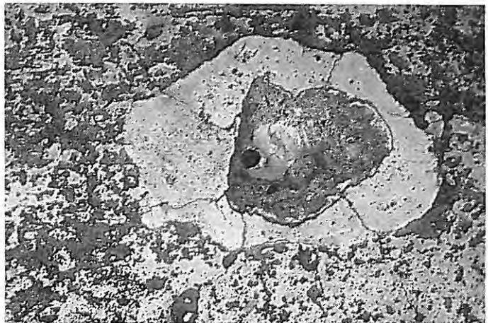
Bild 4 Mörtelabplatzung über einem Zuschlagkorn aus Opalsandstein
