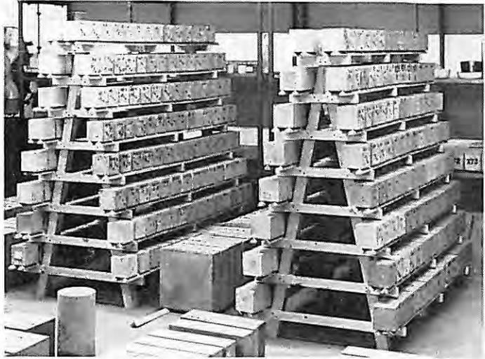
Bild 10 Trockenlagerung im Klimaraum (20 °C und 65 % rel. Luftfeuchte)
