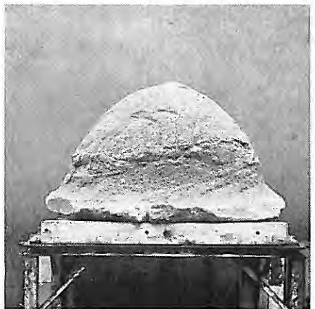
Bild 8 Beispiele für die bei den Einpreßversuchen entstandenen großen Probekörper.
