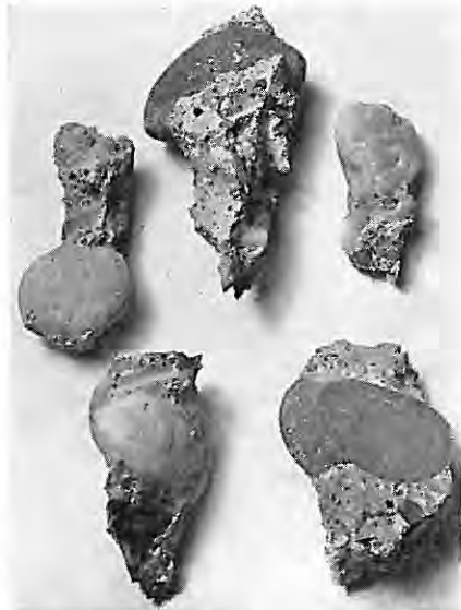
Bild 19 Beim Bruch eines Normalbetonkörpers herausgelöste Zuschlagkörner
