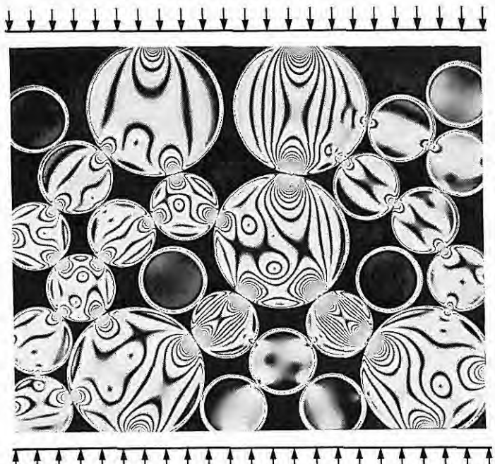
Bild 10 Spannungsverteilung in den Zuschlagkörnern eines belasteten Normalbetonmodells ohne Matrix (Isochromatenbild)
