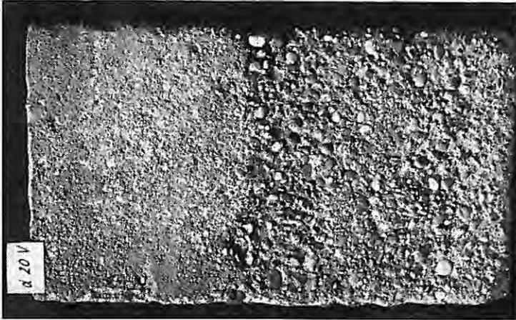
**Bild 9** Betonplatte d20v; **Grad 5** im wassergelagerten Teil; Mörtel bis rd. 7 mm Tiefe über und zwischen den Kieskörnern abgetragen (Luftgelagerter Teil; Feinmörtel etwas abgetragen; **Grad 1**)
