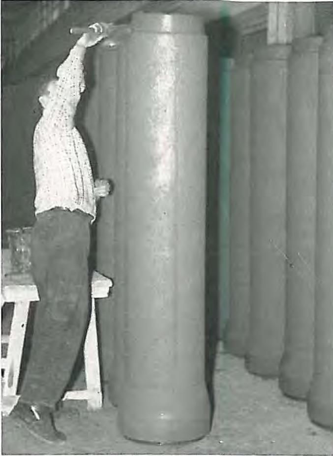
Bild 3 Herstellung von 2 m langen, dünnwandigen Betonrohren
