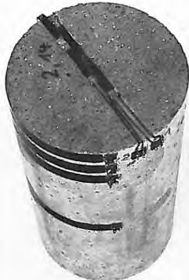
Bild 4 Betonzylinder (15/30 cm) mit Dehnungsmeß- streifen in einer ein- gefrästen Nut der Druckfläche und auf dem Zylindermantel
