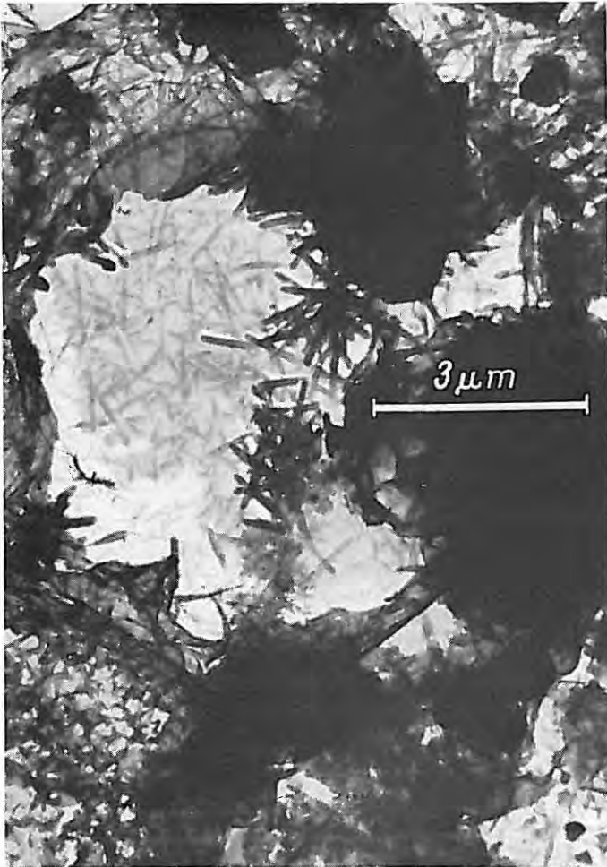
Bild 6 Elektronenmikroskopische Aufnahme des Gefüges einer Tricalciumsilicatpaste im Alter von 7 Tagen, deren Erhärtung durch Zusatz von 1 Gew.-% Calciumchlorid beschleunigt wurde; W/Z = 0,44 (Kohlehülle)
