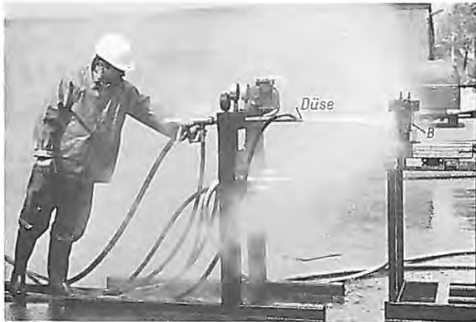
Bild 1 Versuchseinrichtung zur Prüfung des Widerstands von Beton (B) gegen einen mit Luft vermischten Hochdruckwasserstrahl
