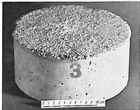
Bild 10 Probezylinder Nr. 3 (Versuchsserie II) mit Besenstrich, abgesäuert, im Ausgangszustand (Beton a mit 55 % Basalt 7/30 mm). — Gleitbeiwert im Ausgangszustand 0,59, nach Beanspruchung 0,42 (siehe Tafel 5).
