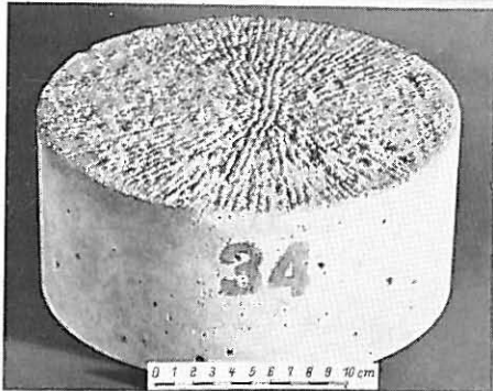
Bild 12 Probezylinder Nr. 34 (Versuchsserie II) mit Mittelriefelung, abgesäuert, im Ausgangszustand (Beton b mit 70 % Kalkstein 3/30 mm). — Gleitbeiwert im Ausgangszustand 0,56, nach Beanspruchung 0,44 (siehe Tafel 5).
