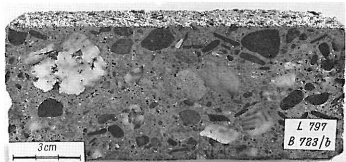
Bild 16 Fahrbahnfläche und Gefüge des Deckenbetons einer Landstraße. 300 kg Zement/m 3 , w = 0,45; 60 % Rheinsand 0/7 mm und Rheinkies bis rd. 30 mm. Baujahr 1964, 1 Jahr unter Verkehr.
