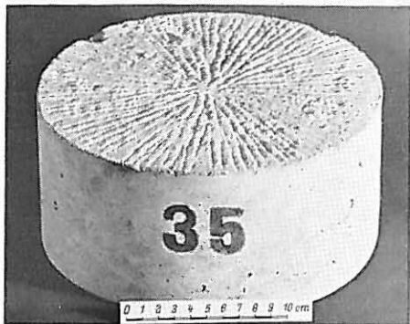
Bild 11 Probezylinder Nr. 35 (Versuchsserie II) mit Mittelriefelung im Ausgangszustand (Beton b mit 70 % Kalkstein 3/30 mm). — Gleitbeiwert im Ausgangszustand 0,30, nach Beanspruchung 0,43 (siehe Tafel 5).
