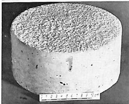
Bild 7 Probezylinder Nr. 1 (Versuchsserie II) mit Besenstrich im Ausgangszustand (Beton a mit 55 % Basalt 7/30 mm). — Gleitbeiwert im Ausgangszustand 0,37, nach Beanspruchung 0,43 (siehe Tafel 5).
