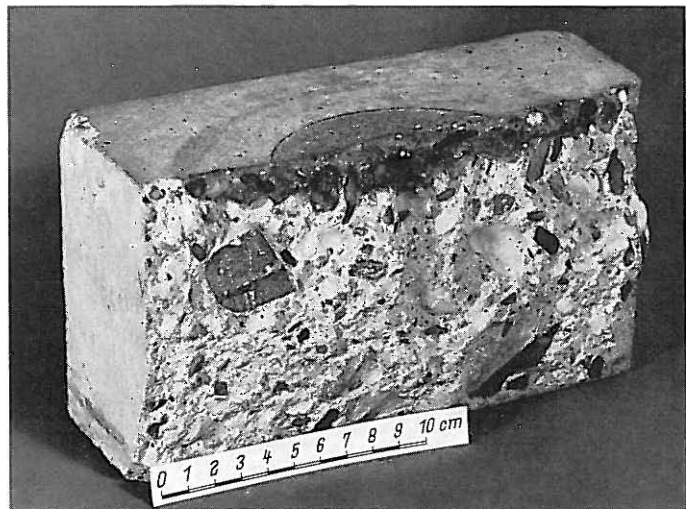
Bild 5 Bruchquerschnitt einer nach DIN 1048 auf Wasserundurchlässigkeit geprüften Betonplatte kurze Zeit nach dem Spalten
