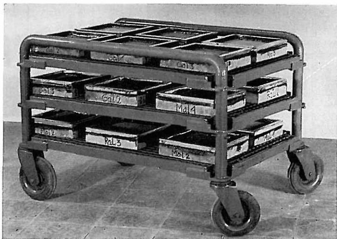
Bild 7 Gehwegplatten in fahrbarem Gestell für die Frost-Tausalz-Wechsel
