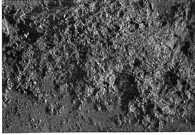
Bild 12 Ausschnitte aus der oberen Fläche der Vorsatzschichten Fza, Ma und Ba mit unterschiedlichem Abwitterungsgrad nach 60 Frost-Tausalz-Wechseln
