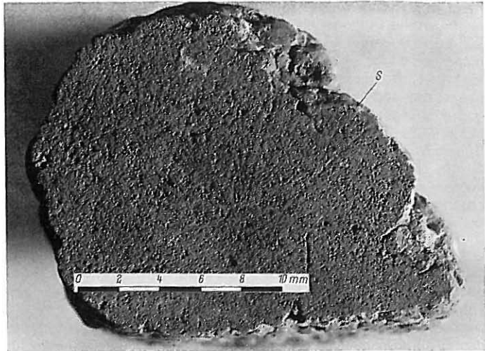
Bild 3 Schnitt durch ein Korn des Blähtons I, Korngruppe 9/25 mm
