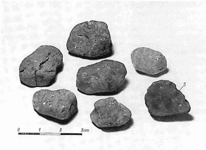
Bild 2 Drehofen-Blähton 9,5/25 mm aus Schieferthon („Idealite“ der Idealite Co., Denver/Col.); Kornrohddichte 1,18 kg/dm 3 (Kornrohddichte der Korngruppe 2,4/9,5 mm rd. 1,3 kg/dm 3 ); Betonfestigkeit W_{28} rd. 500 kp/cm 2 bei einer Rohddichte von 1,50 kg/dm 3
