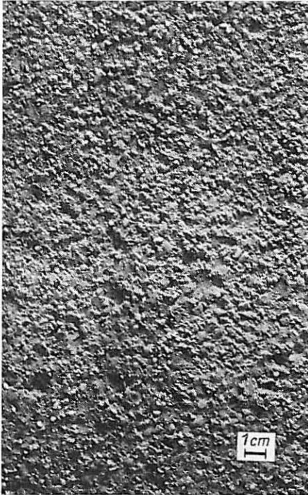
Bild 13 Reihe 20 L: Luftporen- gehalt rd. 3,5 ‰; Zu- stand nach 90 Frost- Tausalz-Wechseln; Bei- spiel für Schadens- stufe 2 (Abwintern des Feinmörtels)
