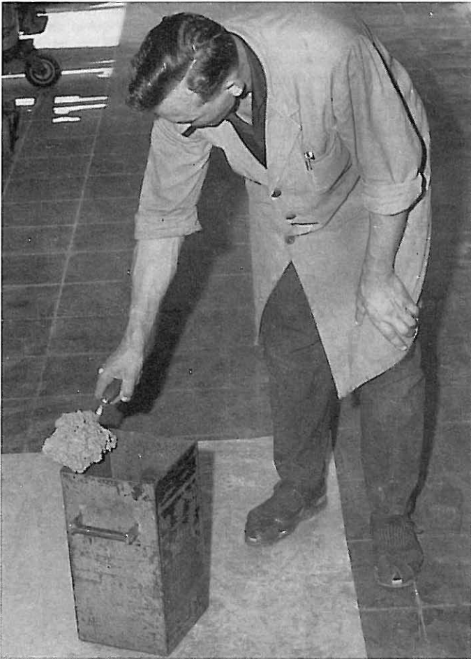
Bild 18 Füllen des Behälters zur Bestimmung des Verdichtungsmaßes v [11]
