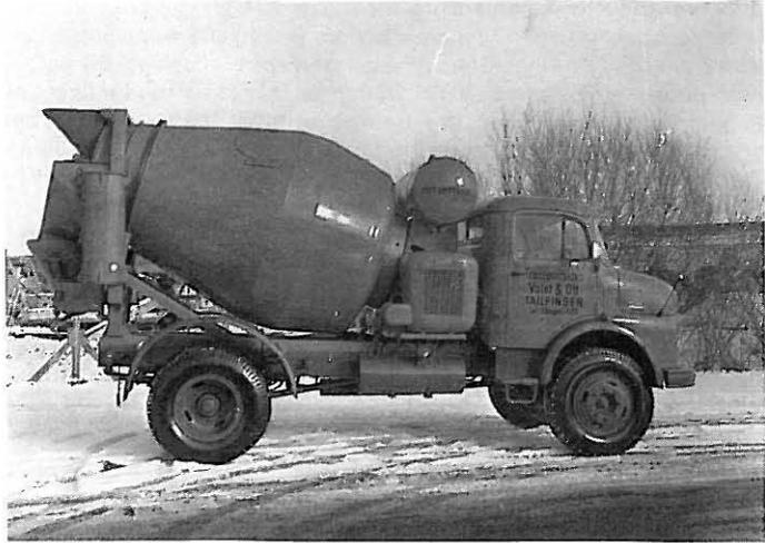
Bild 6 Mischerfahrzeug für 3,5 m<sup>3</sup> Beton. Werkfoto: Stetter KG, Memmingen
