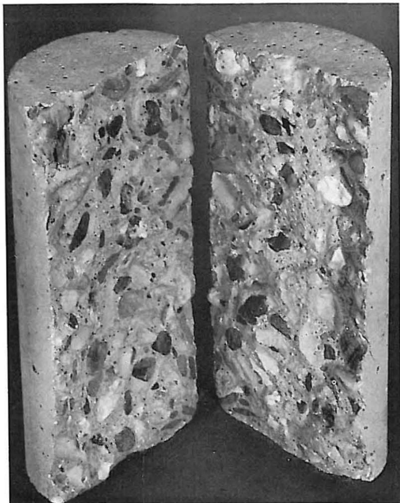
Bild 3 Bruchhälften des Zylinders nach der Spaltzugprüfung
