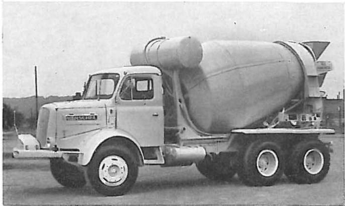
Bild 8 Mischerfahrzeug, 5,5 m<sup>3</sup>, auf Doppelachsen. Die Kraft für den Antrieb der Mischtrommel wird vorne am Fahrzeugmotor entnommen.
