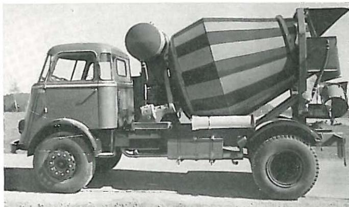
Bild 7 Mischerfahrzeug, 3,5 m<sup>3</sup>, mit eigenem Motor für die Mischtrommel.
