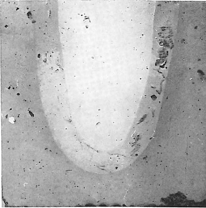
Bild 5 Ausblühungen nach dem abgewandelten Pfützenversuch auf einer senkrecht stehenden Seitenfläche eines Würfels aus Beton B 450
