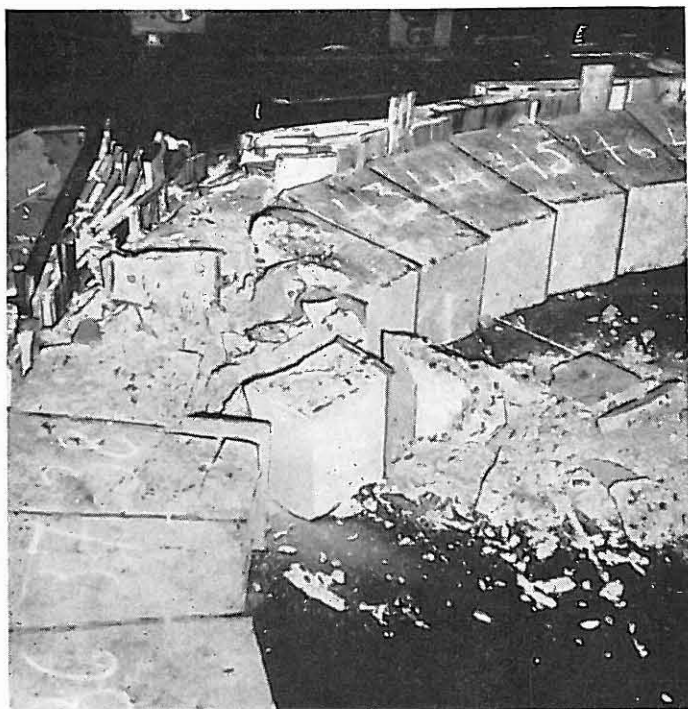
Bild 29 Bruch des Formsteinringes durch Spalten der Steine. Die Zwischenlagen waren Nové-Platten von 10 mm Dicke mit einem Raumgewicht von 0,55 kg/dm 3
