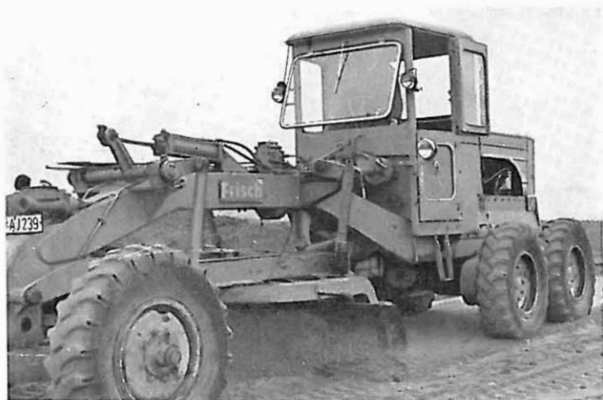
Bild 14 Motorgrader zum Profilieren des Planums
