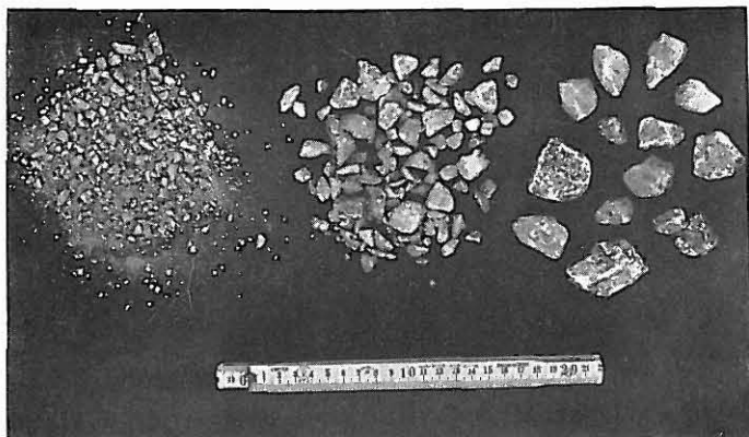
Bild 5 Gebrochener Baryt; Korngruppen 1...7 mm, 7...15 mm und 15...30 mm
