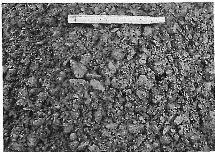
Bild 7 Frischer, unverdichteter Barytbeton aus 13 Gew.-% Natursand 0...3 mm und 87 Gew.-% gebrochenem Baryt 0...30 mm; (Feinmörtel im Beton schmierig-teigig)
