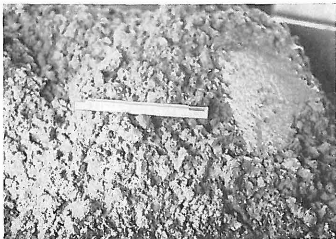
Bild 9 Unverdichteter Barylbeton für den Kernreaktor Geesthacht mit zweckmäßiger Konsistenz (Eindringmaß nach DIN 1048 e = 6 cm)
