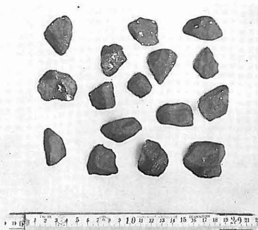
Bild 3 Magnetitzuschlag; Korngruppe 15 . . . 40 mm
