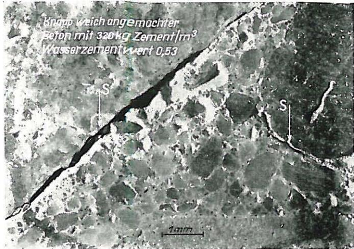
Bild 5 Schnitt durch Beton mit zwei durch Schrumpfen und Wasserabsondern entstandenen Spalte S unter größeren Zuschlagkörnern
